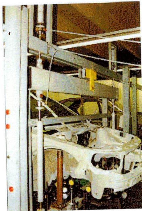
Ilustração 3 - Preparação da carroceria no dispositivo de teste de torsional stiffness .
