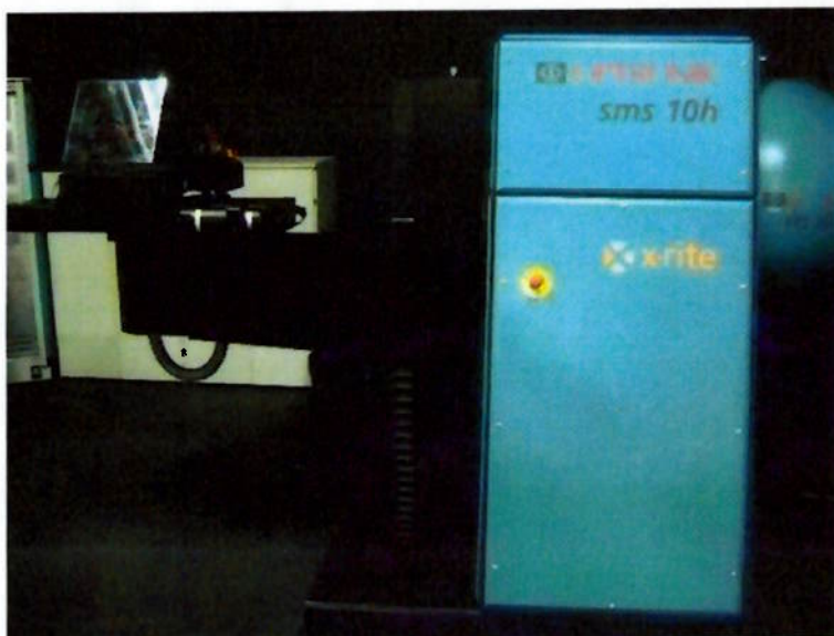
Figura 3.9- Parte do equipamento de transmissão luminosa que emite a luz
