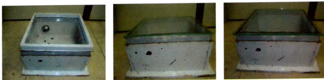
Figura 4.1- Amostras de policarbonato, vidro temperado e vidro laminado após aplicação do teste de resistência mecânica.
