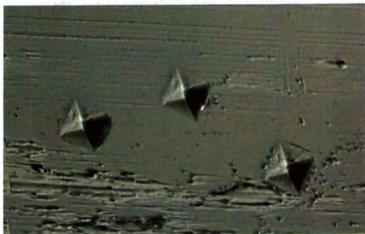
Figura 4.6- Exemplo de Indentações do vidro temperado com uma carga de 100g
