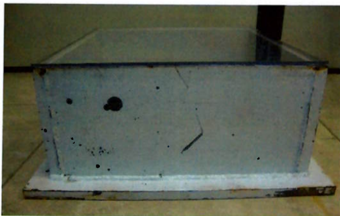
Figura 4.2- Amostra de policarbonato após teste com esfera de 450g
