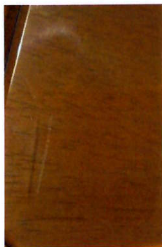
Figura 4.9- Policarbonato após realização do teste de riscabilidade (carga de 20N)
