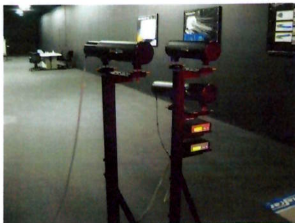
Figura 3.10- Parte do equipamento de transmissão luminosa que recebe a emissão da luz
