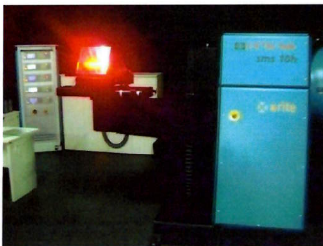
Figura 4.11 Recepção da luz através das amostras para o teste de transmissão luminosa.
