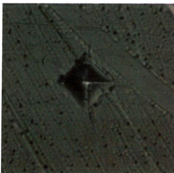
Figura 4.5- Exemplo de Indentação do vidro plano com uma carga de 200g
