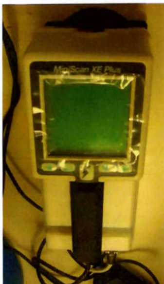
Figura 3.8- Equipamento de medição da transmissão luminosa (Hunterlab)
