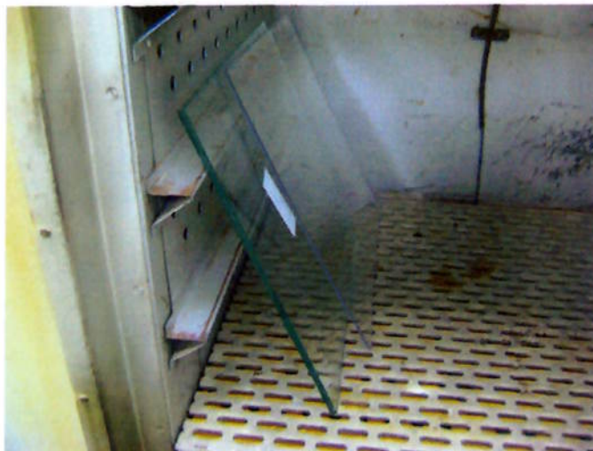
Figura 4.10- Amostras de policarbonato e vidro laminado após 24 horas na estufa a 100°C
