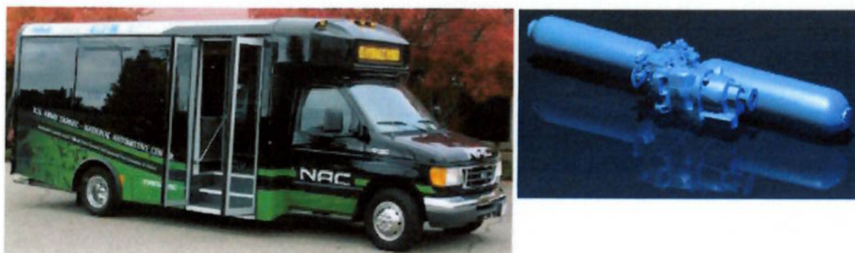
Figura 4.8 – Ford E450 com sistema híbrido hidráulico paralelo HLA da Eaton Fonte : Bohlmann (2007)
