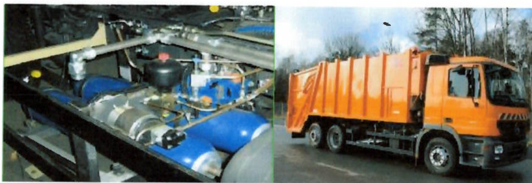
Figura 4.10—Ilustração de um Sistema híbrido hidráulico em paralelo montado no modelo X2ceco da Empresa Haller
