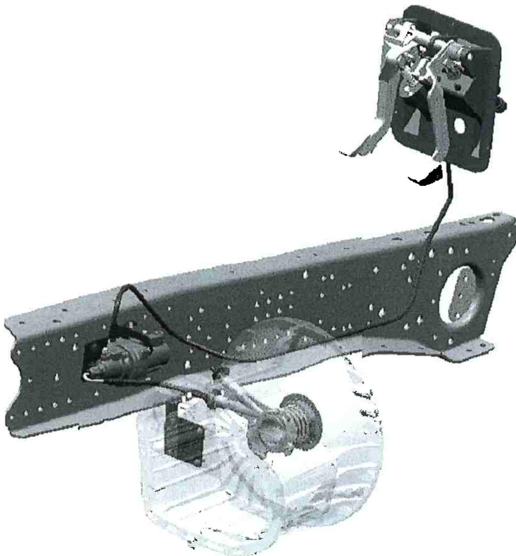
Figura 15: Acionamento hidráulico com CSC e auxílio pneumático
