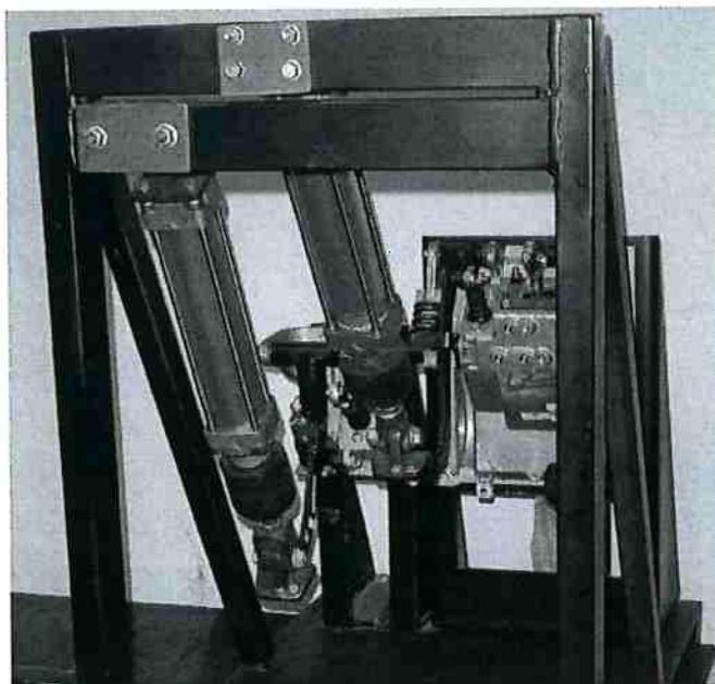
Figura 17: Bancada para teste de durabilidade
