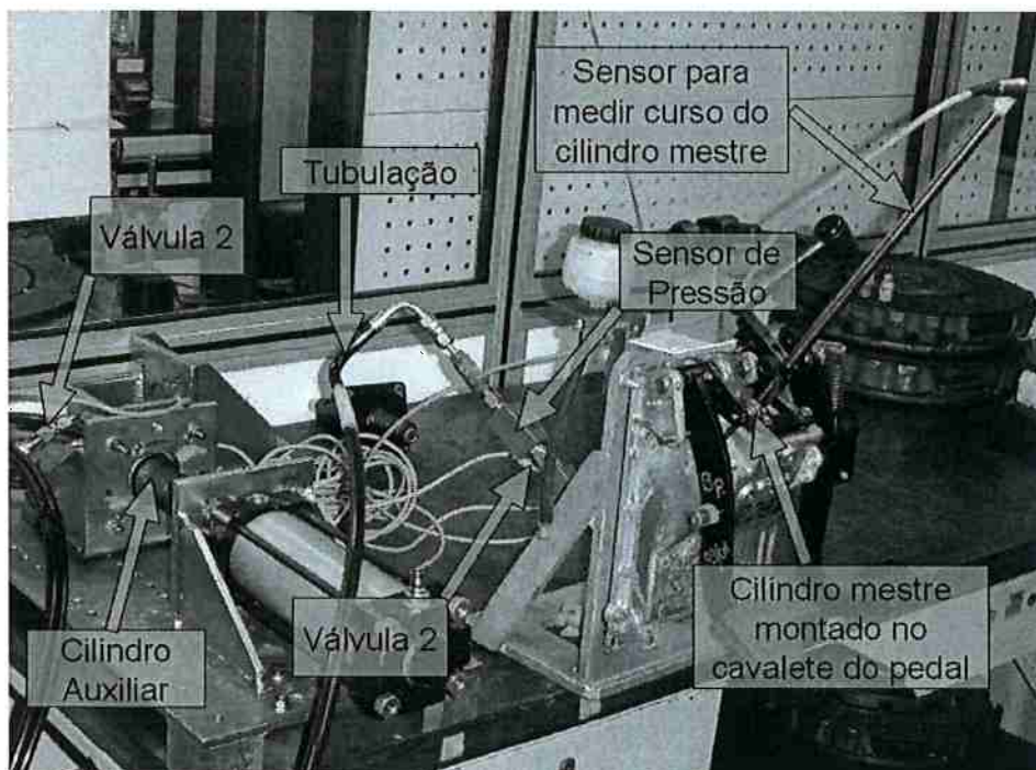
Figura 26: Bancada para verificação de perdas na linha hidráulica
