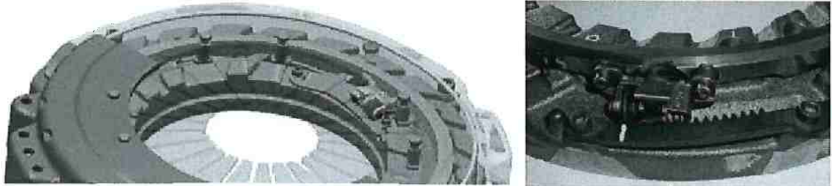
Figura 8: Variante de mecanismo para platô auto ajustável (VALEO, 2004)
