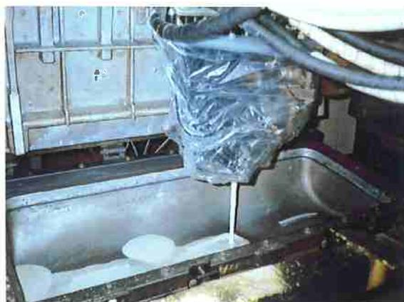
**Figura 3.24** Operação de vazamento da mistura
