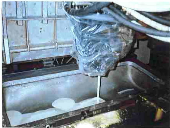
Figura 3.24 Operação de vazamento da mistura
