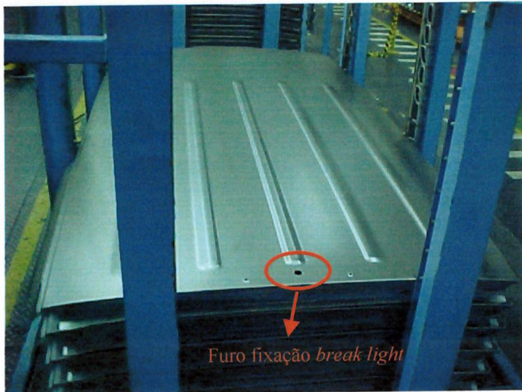
Figura 5.1 - Painel externo do teto: furo fixação do break light
