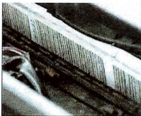
Figura 4.2 Filtro de ar posicionado no evaporador
