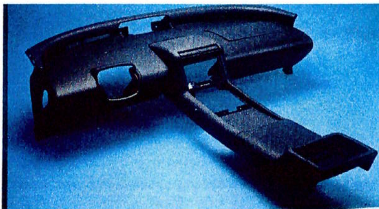
Figura 4.11 – Peça de compósito para fluxo de ar frontal e traseiro
