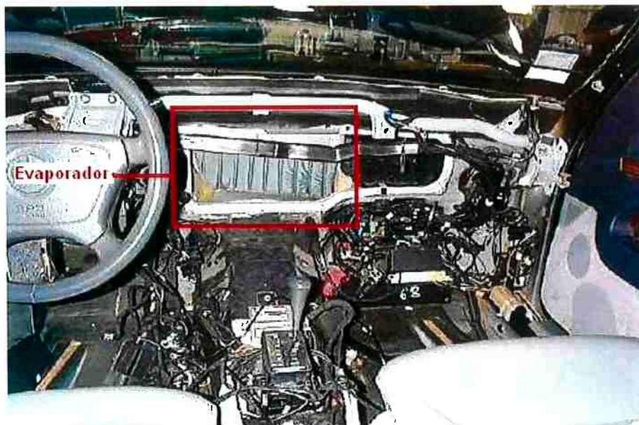
**Figura 3.11** Posição do evaporador no painel de instrumentos.
