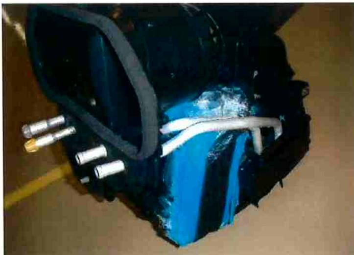
**Figura 6.2** Melhoria na vedação da válvula que faz o isolamento entre o *heater core* e o evaporador.
