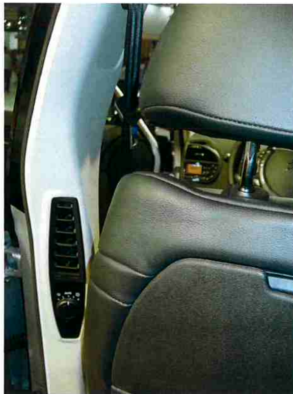
Figura 3.22 Veículo com difusor posicionado na coluna B.
