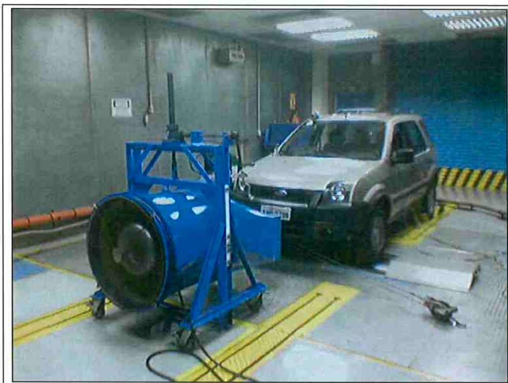
Figura 5.1 Veículo instrumentado em uma câmara climatizada com dinamômetro.
