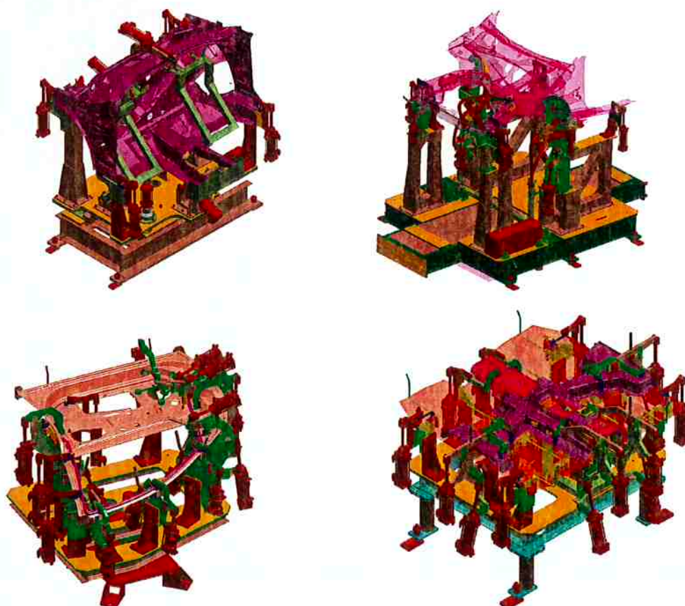
Figura 32 – Exemplos de dispositivos de junção de subconjuntos de carroceria: Compartimento do motor (Front-end), Painel interno da porta dianteira e assoalho dianteiro.
