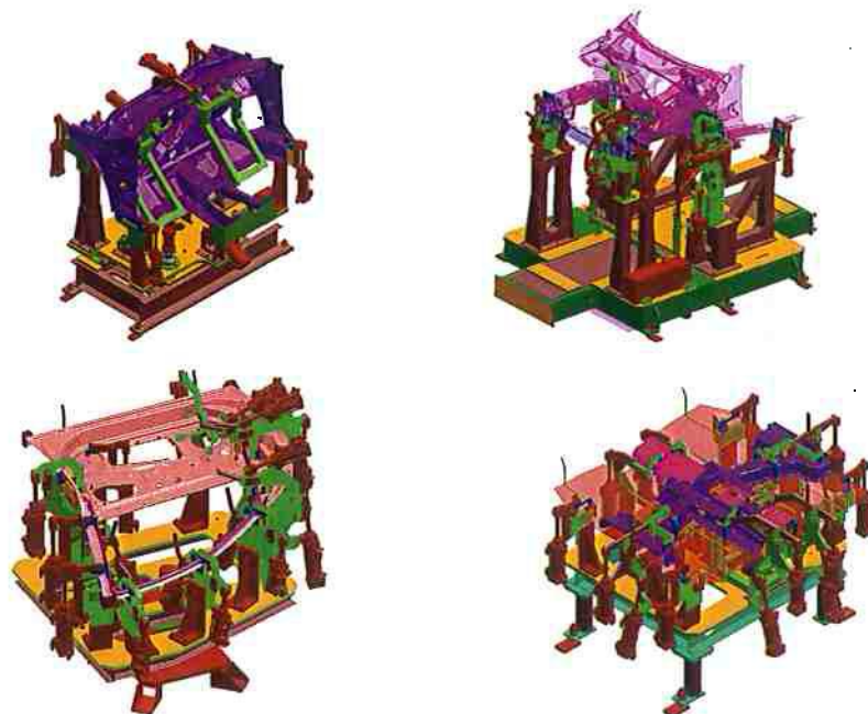
Figura 32 – Exemplos de dispositivos de junção de subconjuntos de carroceria: Compartimento do motor ( Front-end ), Painel interno da porta dianteira e assoalho dianteiro (GMB - Tooling & Fixtures Design, 2004).
