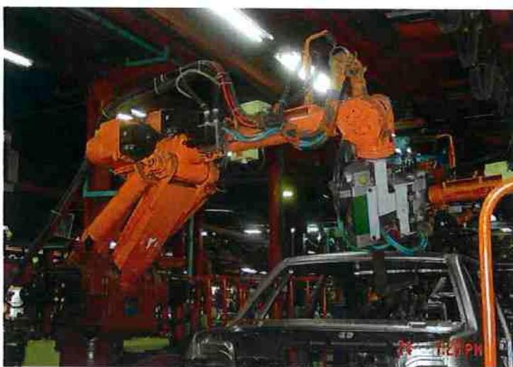
Figura 33 – Estação de solda a ponto automática típica ( http://www.seesaipa.com/Robotics , acesso:5/Fev/2004)
