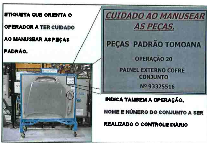
Figura 51 – Identificação do conjunto e recomendações manipulação das peças padrão.
