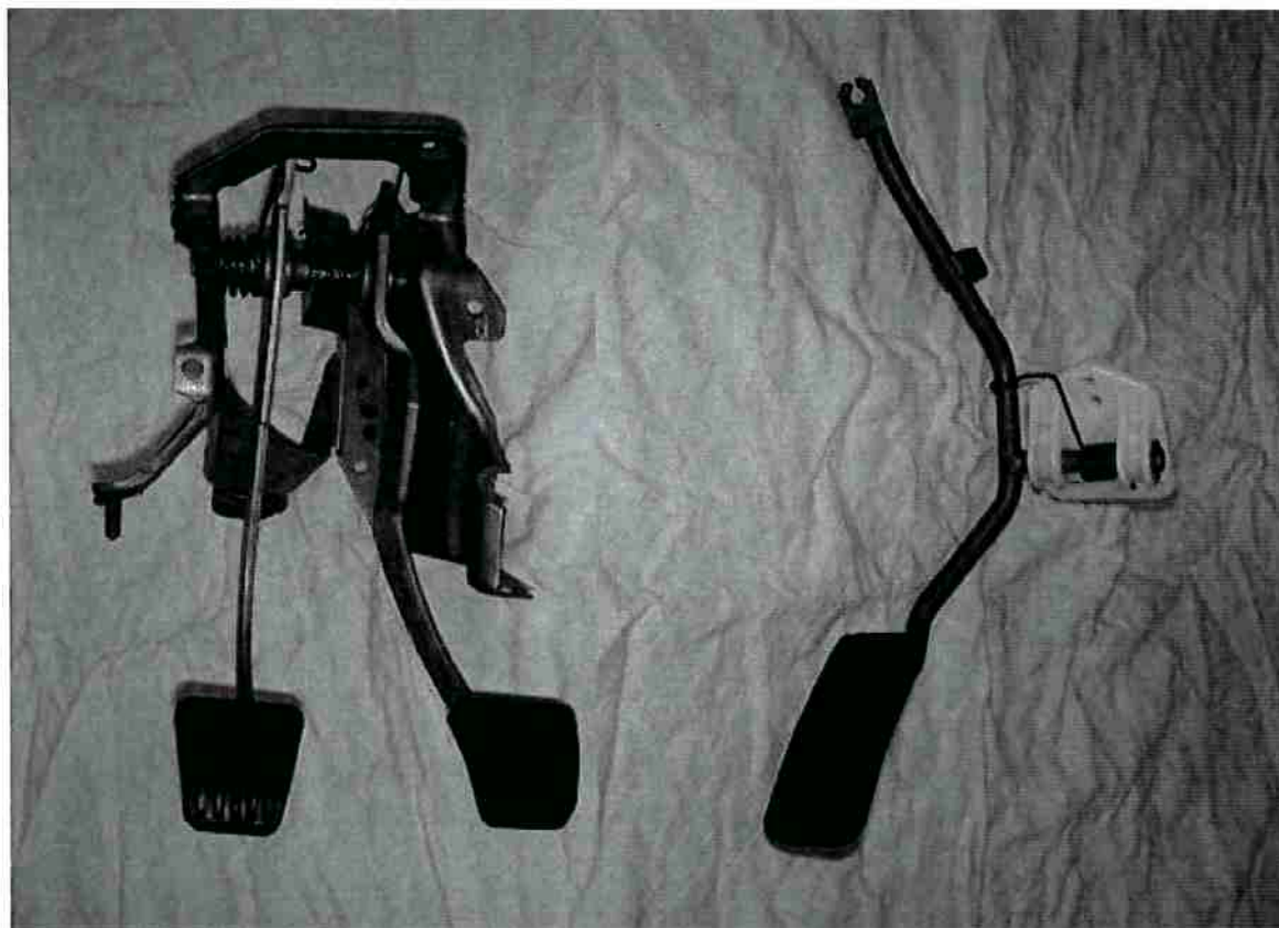
Figura 4 – Conjunto de pedais do veículo GMB montado.
