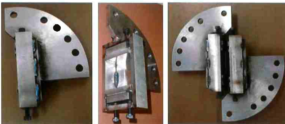
Figura 59 - Fotos do dispositivo de Arcan.
