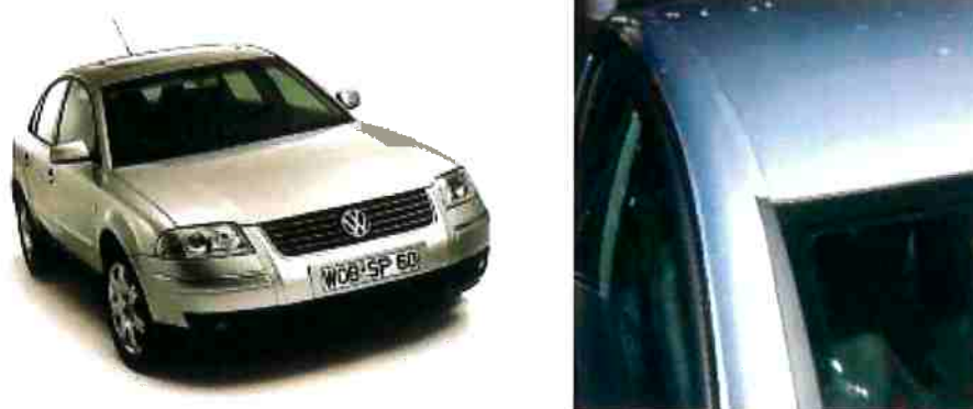
Figura 23 - Aplicação de SL no teto sem adição de material.
