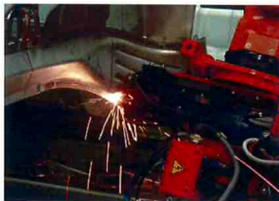
Figura 25 - Aplicação de SL na Longarina Dianteira.
