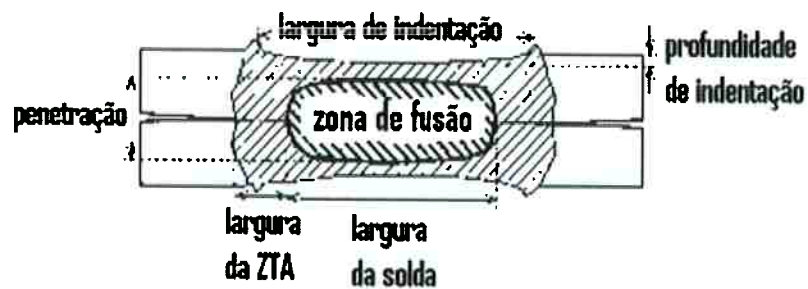
Figura 39 - Configuração de um ponto de solda.
