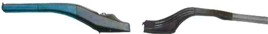
Figura 18 - Longarinas com tailored blank de 3 espessuras.
