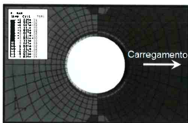
Figura 50 - Análise de tensões em volta do ponto de solda.
