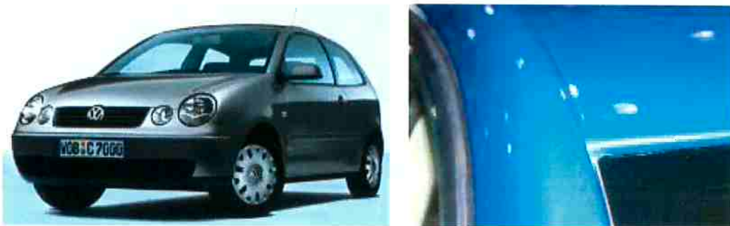
Figura 22 - Aplicação de Brasagem laser no teto com adição de material.
