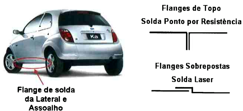
Figura 30 - Junção da Lateral com Assoalho.
