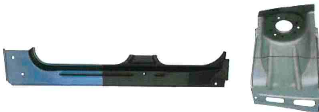
Figura 19 - Reforço Lateral e Torre do Amortecimento com tailored blank de 2 espessuras.
