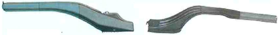
Figura 18 - Longarinas com tailored blank de 3 espessuras.
