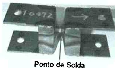
Figura 35 - Corpo de prova do modelo de teste de Lin.
