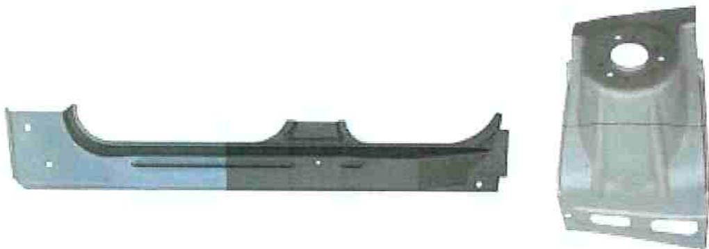
Figura 19 - Reforço lateral e torre do amortecedor com tailored blank de 2 espessuras.
