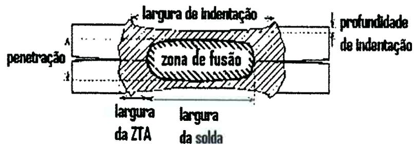
Figura 39 - Configuração de um ponto de solda.
