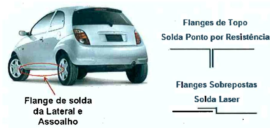
Figura 30 – Exemplo de junção da lateral com assoalho.
