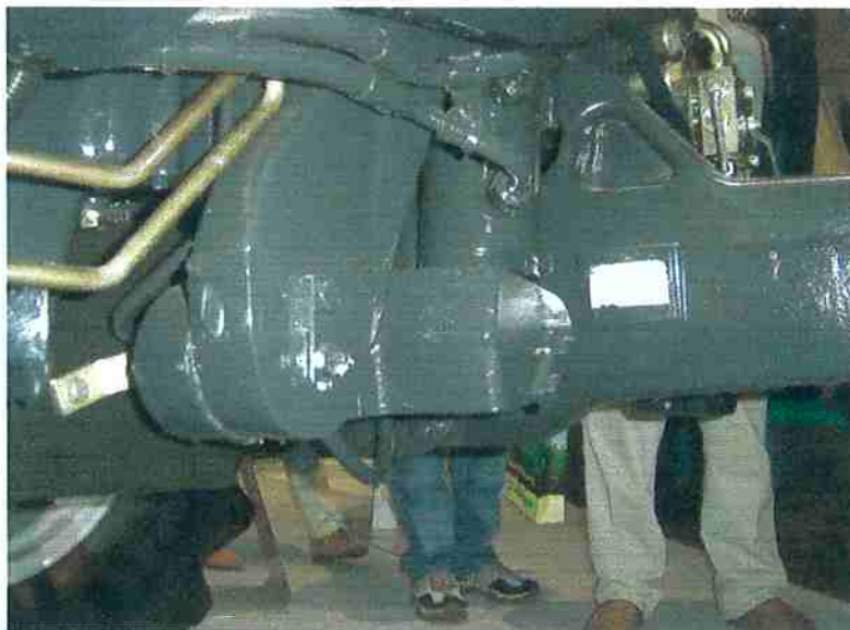
Figura 2.1.2.5 – Eixo rígido, suspenso com cilindros hidráulicos.
