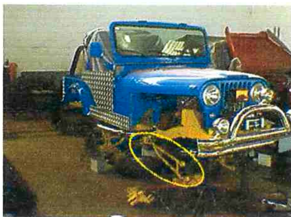
Figura 12.4 – Veículo Willis montando o eixo dianteiro. Pode-se observar claramente as barras de ancoragem do eixo
