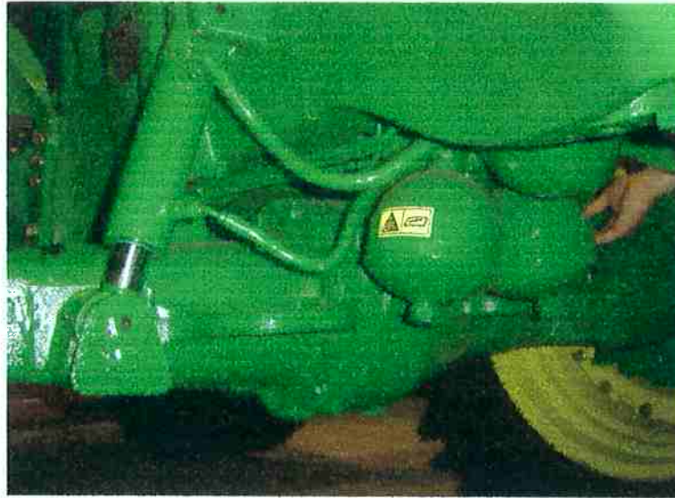
Figura 11.3 – Modelo de suspensão da Jonh Deere. Detalhes dos cilindros de suspensão com os acumuladores de pressão responsáveis pelo gerenciamento da suspensão.
