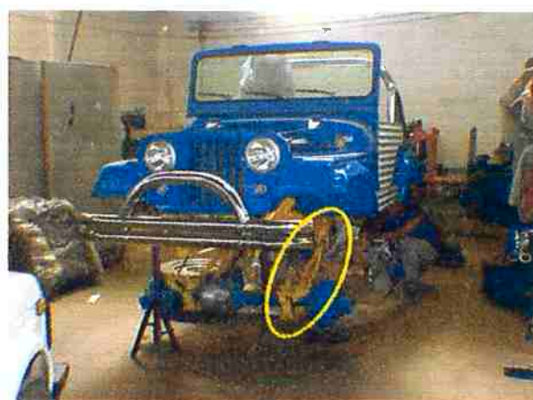
Figura 12.4 – Veículo Willis montando o eixo dianteiro. Pode-se observar claramente as barras de ancoragem do eixo
