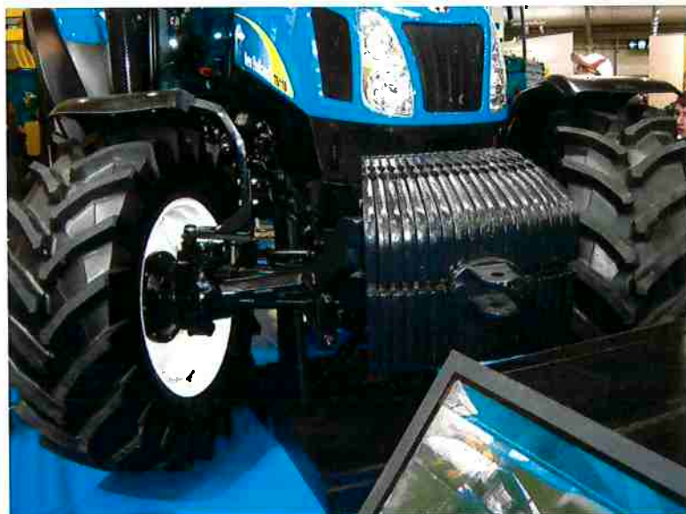
Figura 2.1.2.4 – Modelo de trator CNH: eixo rígido com Sobre-Esterçamento.
