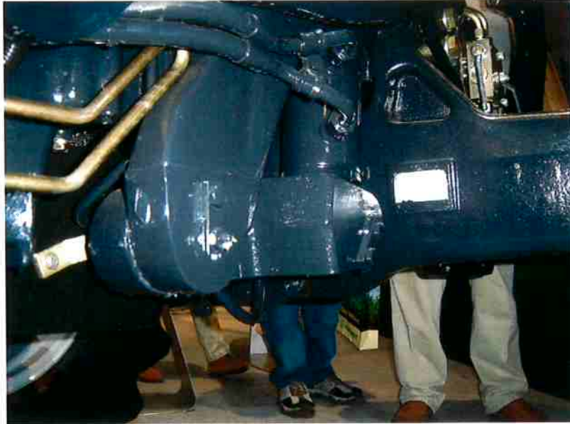
Figura 2.1.2.5 – Eixo rígido, suspenso com cilindros hidráulicos.
