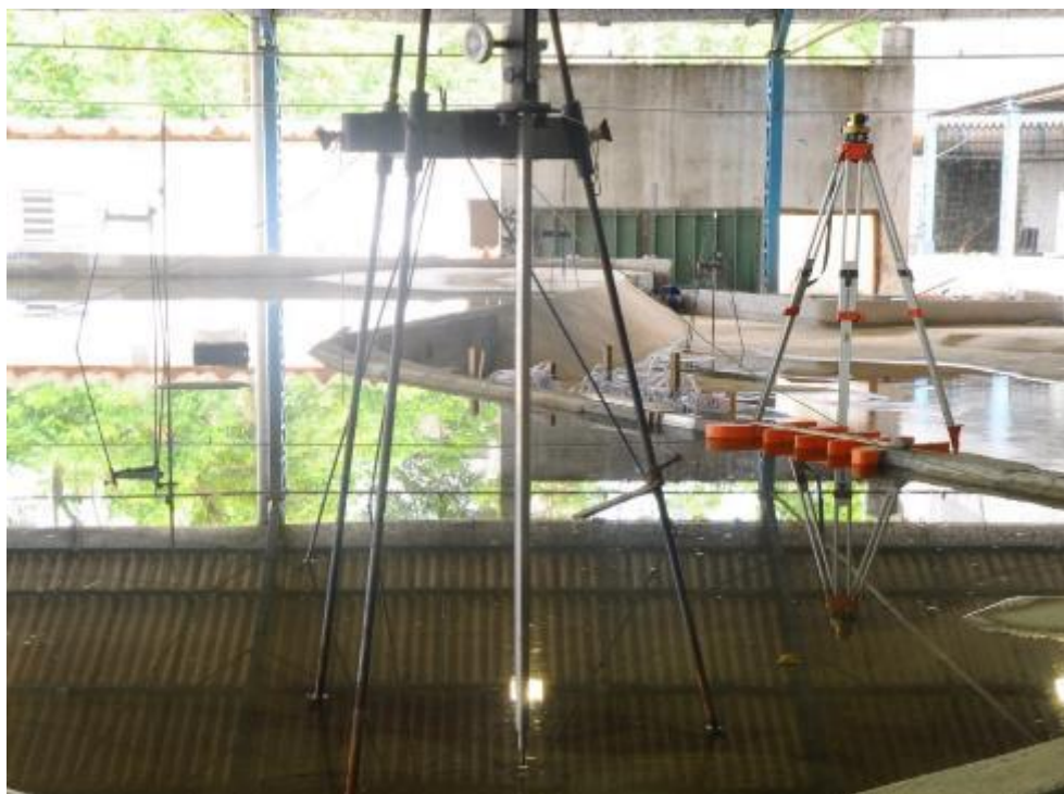
Foto 4.5 - Ponta limnimétrica instalada no modelo físico para medição de nível d'água médio no ponto P3. Fonte: FCTH (2019).
