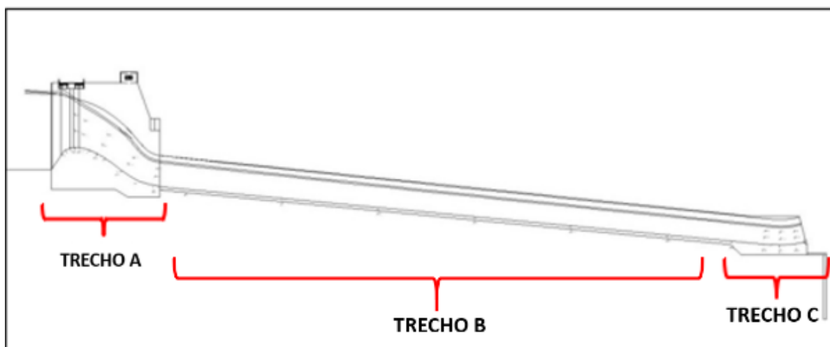
Figura 4.2 - Vista geral do perfil do vertedouro de serviço com divisão de trechos. Fonte: FCTH (2019).
