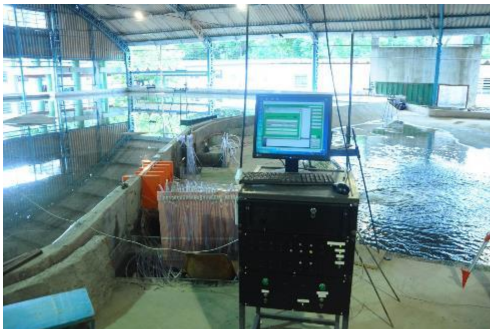
Foto 4.1 - Vista geral do modelo físico da Represa 1 da margem direita para a esquerda, com destaque para o sistema de aquisição de dados de velocidade e pressão. Fonte: FCTH (2019)
