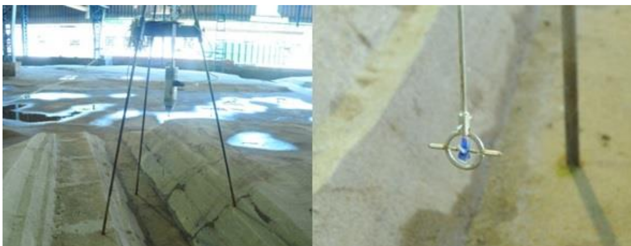
Foto 4.6 - Micromolinete instalado no modelo físico (à esquerda) e detalhe da hélice (à direita). Fonte FCTH (2019).
