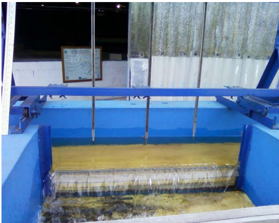
Foto 2.8 – escoamento por um vertedor lateral em modelo físico de escala reduzida. Fonte: Dias (2011)
