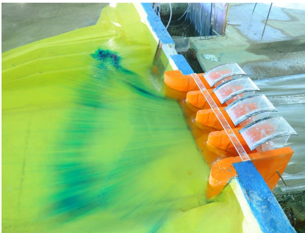
Foto 5.2 – Registro fotográfico do escoamento a montante do VTS no modelo reduzido, com destaque para a utilização de traçador (corante) para identificação do fluxo. Simulação de vazão máxima pelo VTS, todas as comportas abertas.
