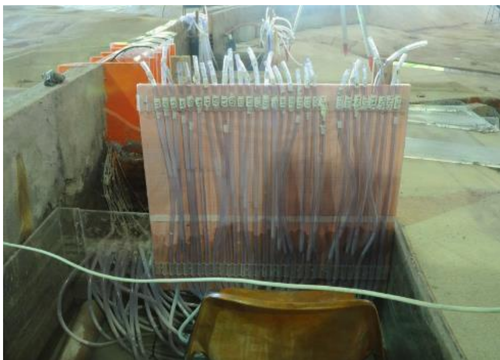
Foto 4.8 – Quadro piezométrico para medição de pressões médias. Fonte: FCTH (2019).
