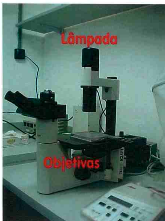
Figura 4.19 - Microscópio invertido utilizado para identificação de gêneros de algas (SANT'ANNA et al., 2006)
