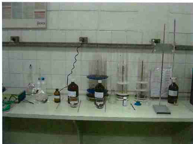
Figura 4.33 - Reagentes e vidrarias utilizadas na determinação de residuais de cloro livre e combinado durante a realização dos ensaios em escala de bancada (FERNANDES, 2008)
