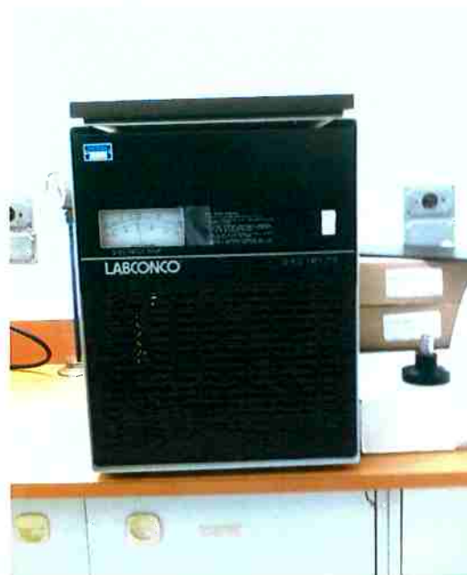
Figura 4.20 - Equipamento utilizado pela CETESB (Shell Freezer) para efetuar o congelamento de amostras de florações de cianobactérias (FERNANDES, 2007)
