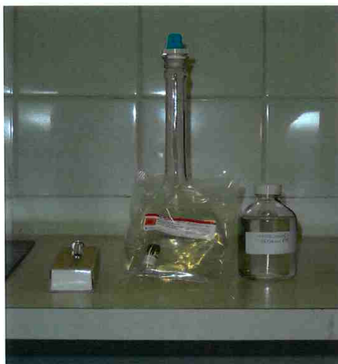
Figura 4.28 - Preparação da solução estoque através da diluição de padrão contendo 500 \mu g de MYC-LR (FERNANDES, 2008)
