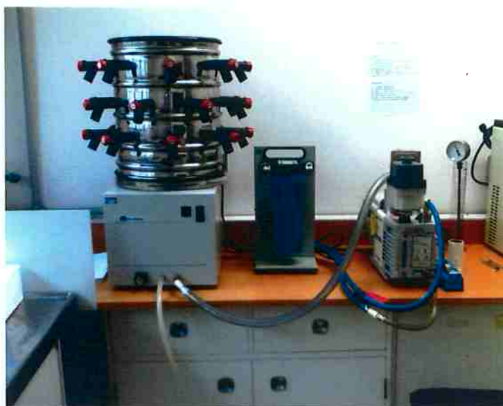
Figura 4.23 - Equipamento utilizado pela CETESB na liofilização de amostras contendo massa algal previamente congelada (FERNANDES, 2007)
