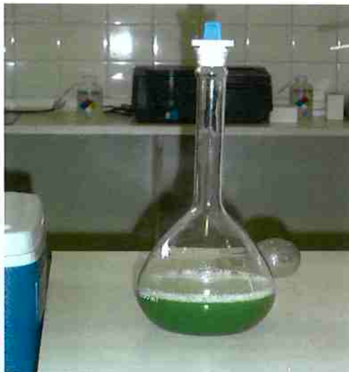
Figura 4.27 - Solução estoque contendo MYC-LR, após a solubilização da massa algal macerada, provocada pelo ultrassom (FERNANDES, 2008)
