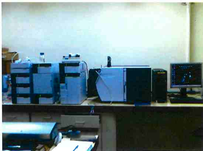
Figura 4.30 – Sistema cromatográfico composto por cromatógrafo líquido, espectrômetro de massa, detector de arranjo de diodos e periféricos, utilizado na identificação e quantificação de cianotoxinas pelo DTFCF – USP (FERNANDES, 2007)
