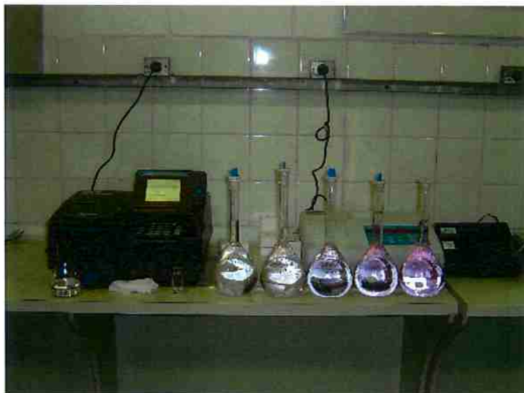
Figura 4.35 - Espectrofotômetro marca Hach, modelo DR4000, utilizado na determinação das concentrações residuais de permanganato de potássio (FERNANDES, 2008)
