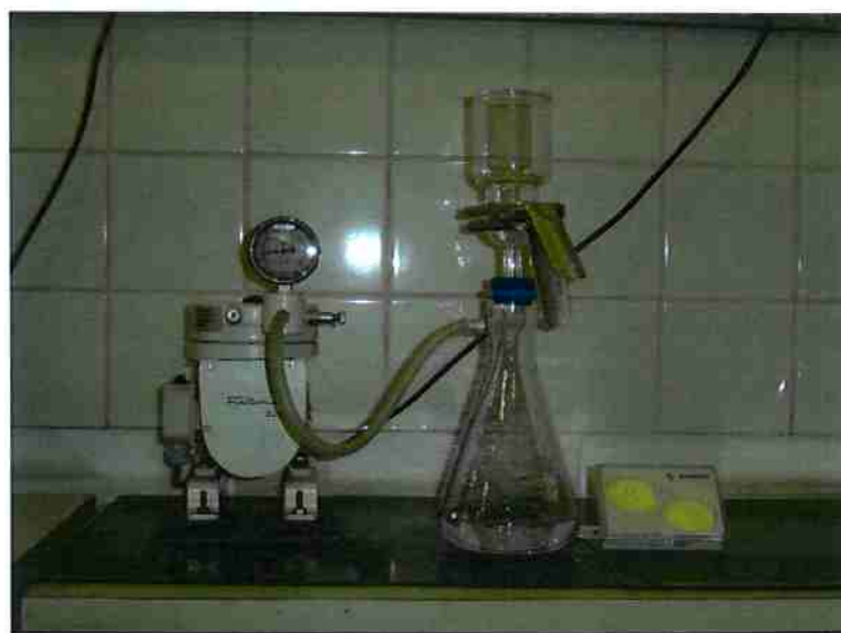
Figura 4.36 - Sistema de filtração e membranas utilizadas na determinação das concentrações residuais de permanganato de potássio (FERNANDES, 2008)
