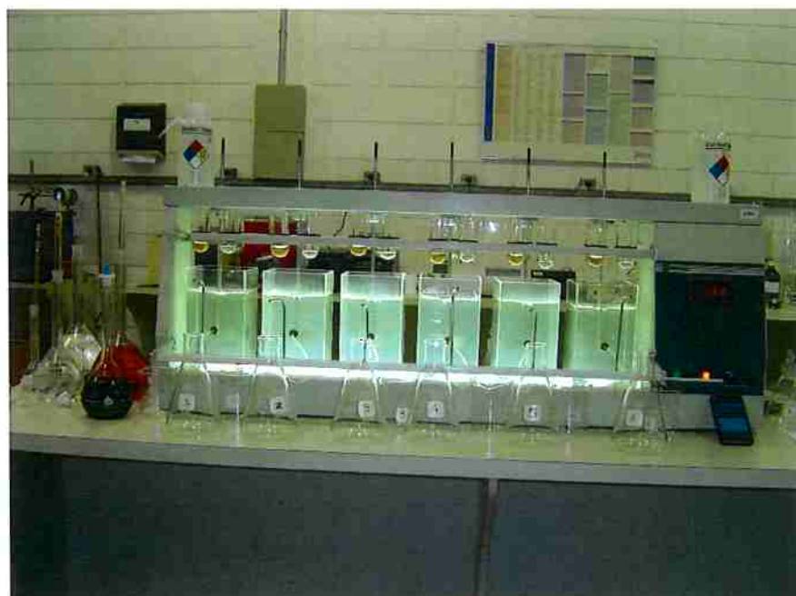
Figura 4.38 - Execução dos ensaios de bancada visando a otimização do tratamento convencional na remoção de MYC-LR (FERNANDES, 2008)
