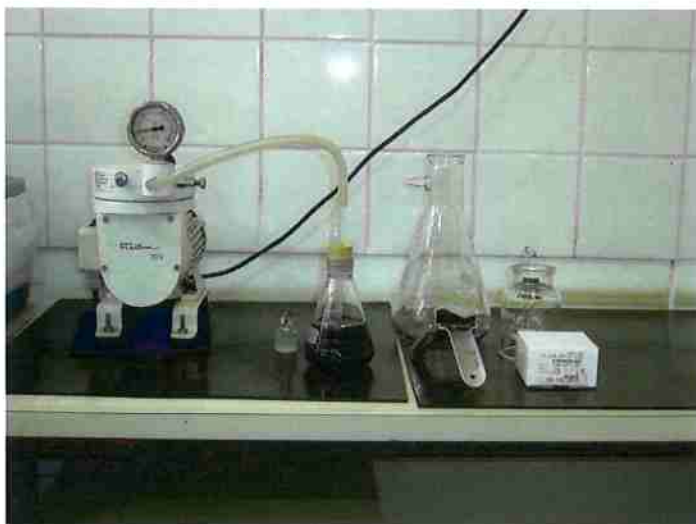
Figura 4.37 - Preparação da suspensão de carvão: aplicação de vácuo para saturar os poros do CAP com água e expulsar o ar (FERNANDES, 2008)
