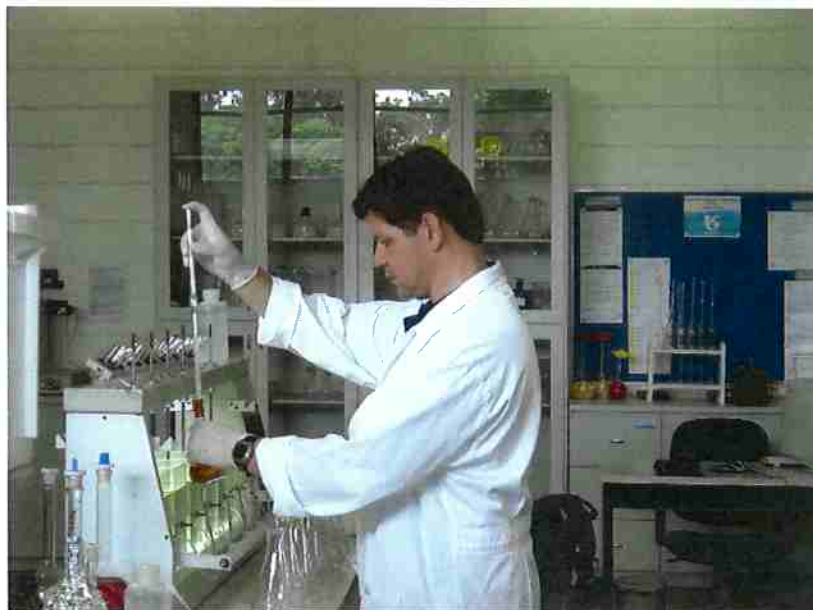
Figura 4.39 - Execução dos ensaios de bancada visando a otimização do tratamento convencional na remoção de MYC-LR (FERNANDES, 2008)
