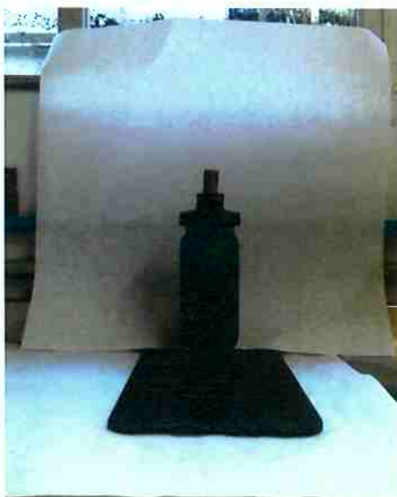
Figura 4.21 - Frasco utilizado pela CETESB durante o processo de congelamento e liofilização de amostras de florações de cianobactérias (FERNANDES, 2007)
