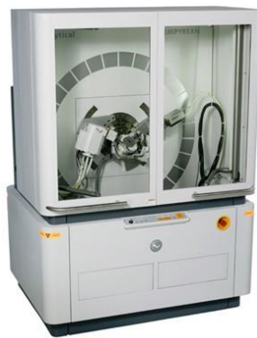
Figura 16 – Difratorômetro de raios X Empyrean, Panalytical utilizado para caracterização mineralógica.
