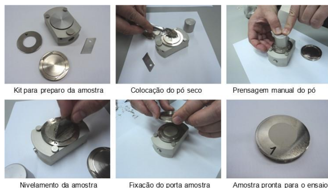
Figura 15 – Etapas para a preparação da amostra para o ensaio de difração de raios X.
