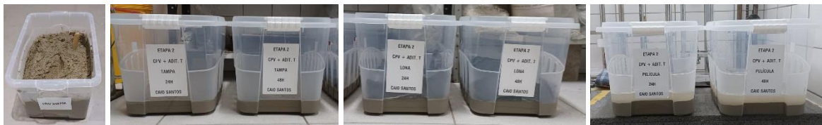
Figura 29 – Mistura e armazenamento das argamassas de CPV com AEH – T. Da esquerda para a direita: homogeneização; caixas apenas tampadas (24h e 48h); argamassas cobertas com lona e caixas tampadas (24h e 48h); argamassas com película de água e caixas tampadas (24h e 48h).
