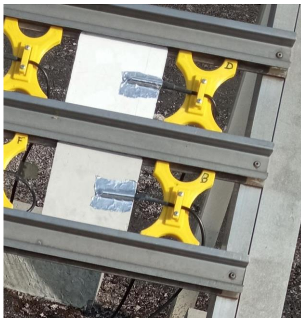
Figura H2 – Detalhe da fixação dos termopares nas amostras expostas em São Paulo
