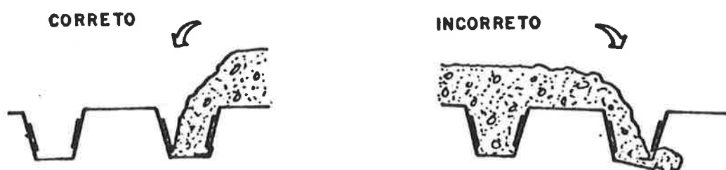
Figura 3.35 - Importância do correto sentido de lançamento do concreto. (31)
