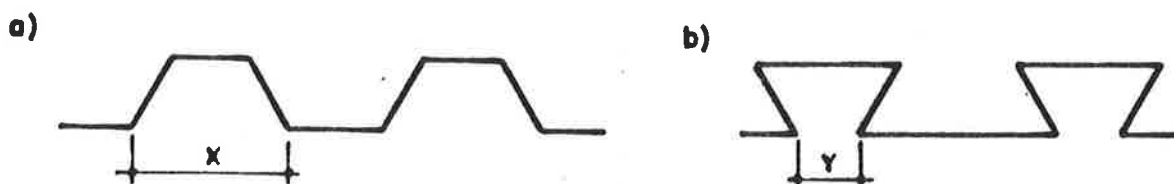
Figura 4.32 - Acessibilidade à região interna das chapas dobradas: a) perfil trapezoidal; b) perfil "rabo-de-andorinha".
