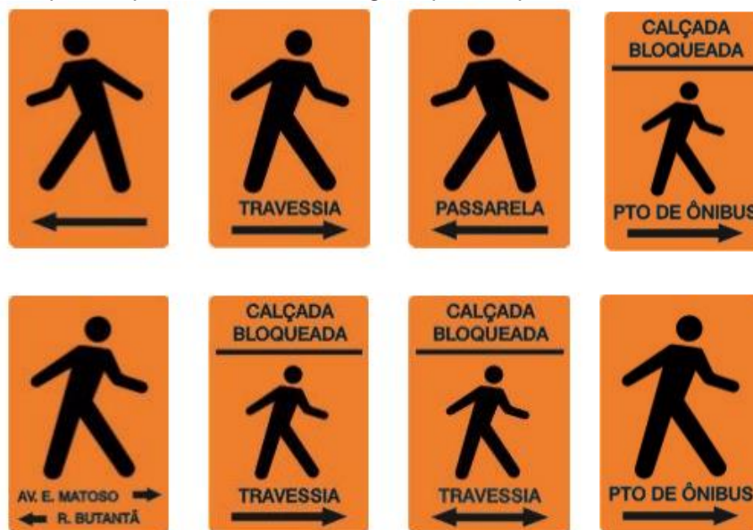
Figura 9 - Exemplos de placas orientativas dirigidas para os pedestres sobre interferência na via
