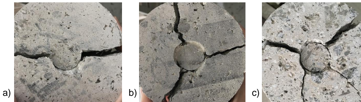
Figura 18 - Mecanismos de fratura ocorridos presentes a campanha de ensaios. a) 2 fissuras radiais; b) 3 fissuras radiais; c) 4 fissuras radiais.
