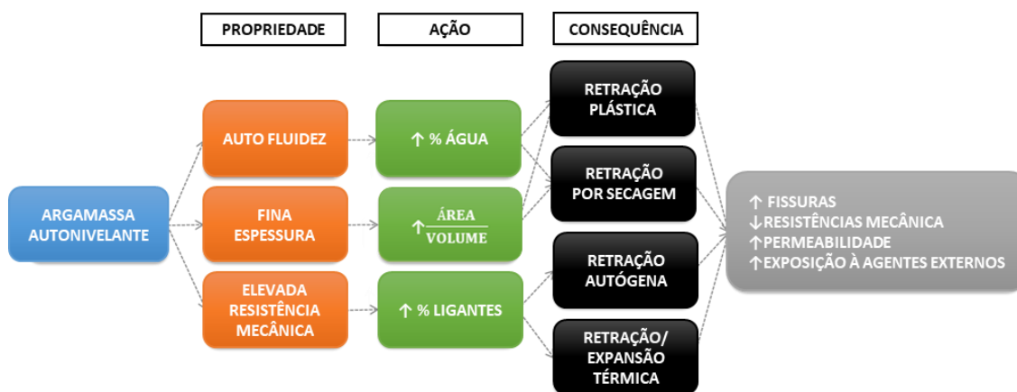
Figura 6 - Diagrama de propriedades, ações necessárias para alcançá-las e consequências que podem causar manifestações patológicas em argamassas autonivelantes.
