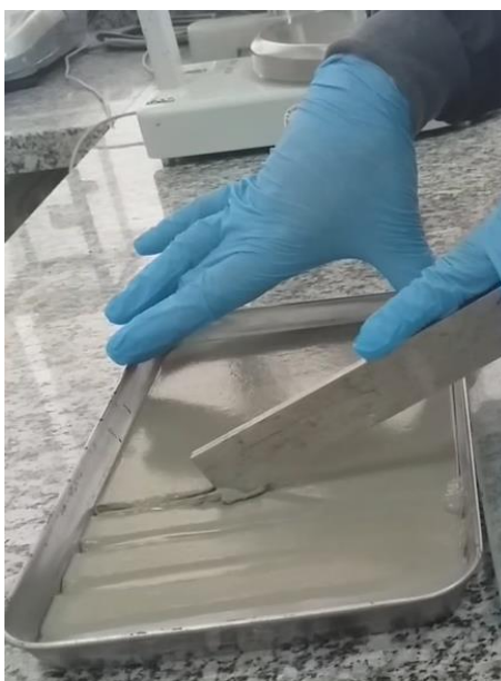
Figura 37 – Demonstração do teste para obtenção do tempo de trabalhabilidade de argamassas autonivelantes (Healing time) onde cortes são feitos a cada 5 minutos.
