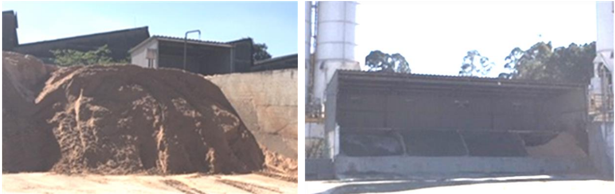
Figura 6: Estocagem de areias na Central da Supermix em Diadema/SP, à esquerda a areia de quartzo estocada em depósito descoberto e à direita a areia artificial estocada em depósito coberto. Fotos tiradas pela autora durante visita técnica.
