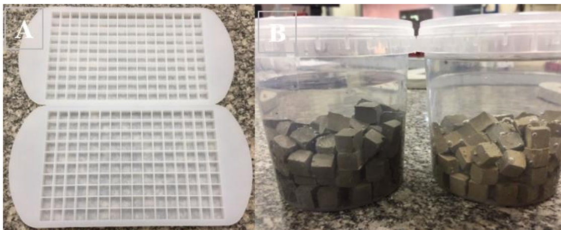
Figura 4-14. Moldes de silicone para corpos de prova (amostras) cúbicos ( 1\text{cm}^3 )(A) e corpos de prova (amostras) submersos em água, em cura (B).
