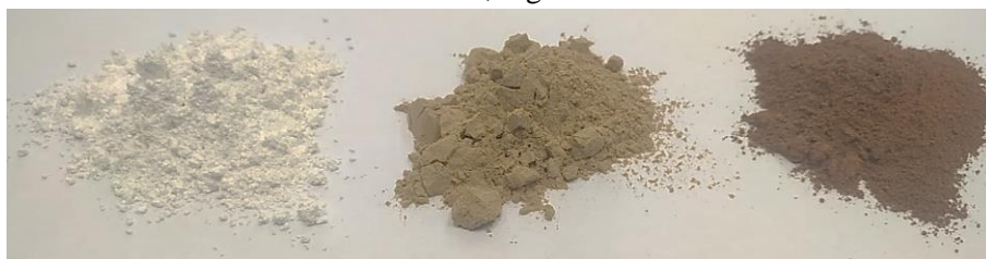
Figura 4-2 – Matérias-primas utilizadas para produção de clínquer Portland. Da esquerda para direita: \text{CaCO}_3 , argila e HI-IOT.
