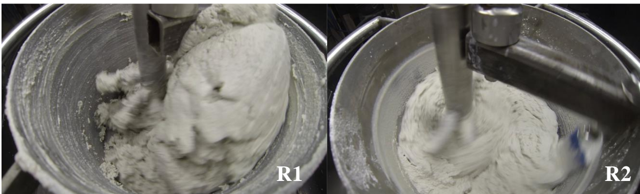
Figura 46 - Mistura de argamassa de revestimento nas configurações R1 e R2. Fonte: Elaborado pelo autor.
