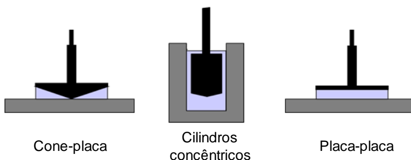
Figura 5 - Geometrias utilizadas em reômetros: Cone-placa, cilindros concêntricos e placa-placa. Fonte: Elaborador pelo autor.
