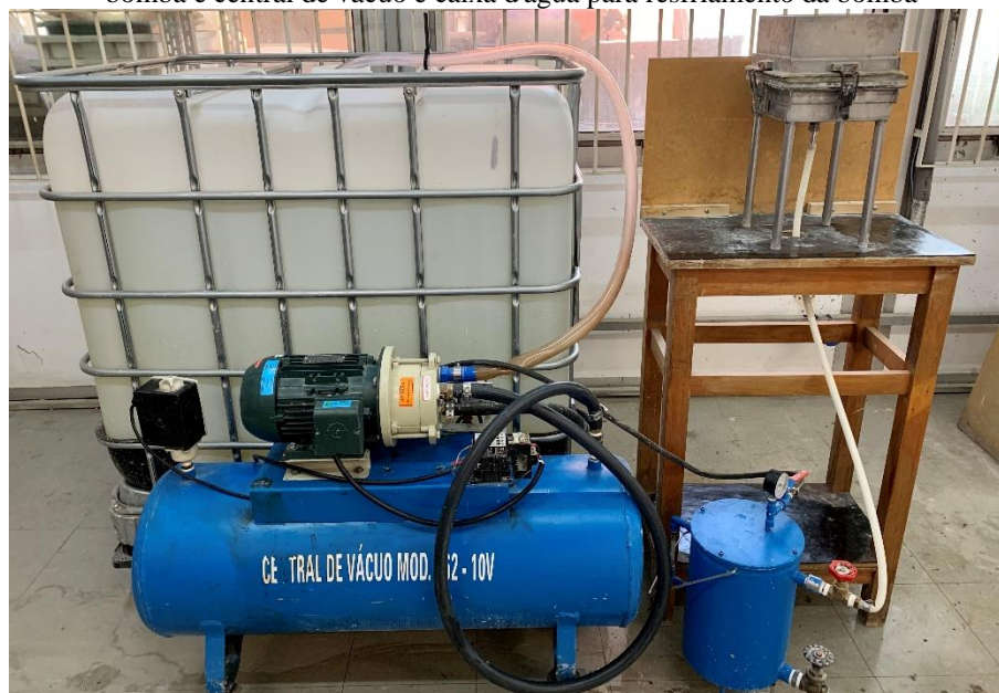
Figura 32 – Sistema de moldagem de fibrocimento com aparato de filtragem por tamis, sucção à vácuo por bomba e central de vácuo e caixa d'água para resfriamento da bomba
