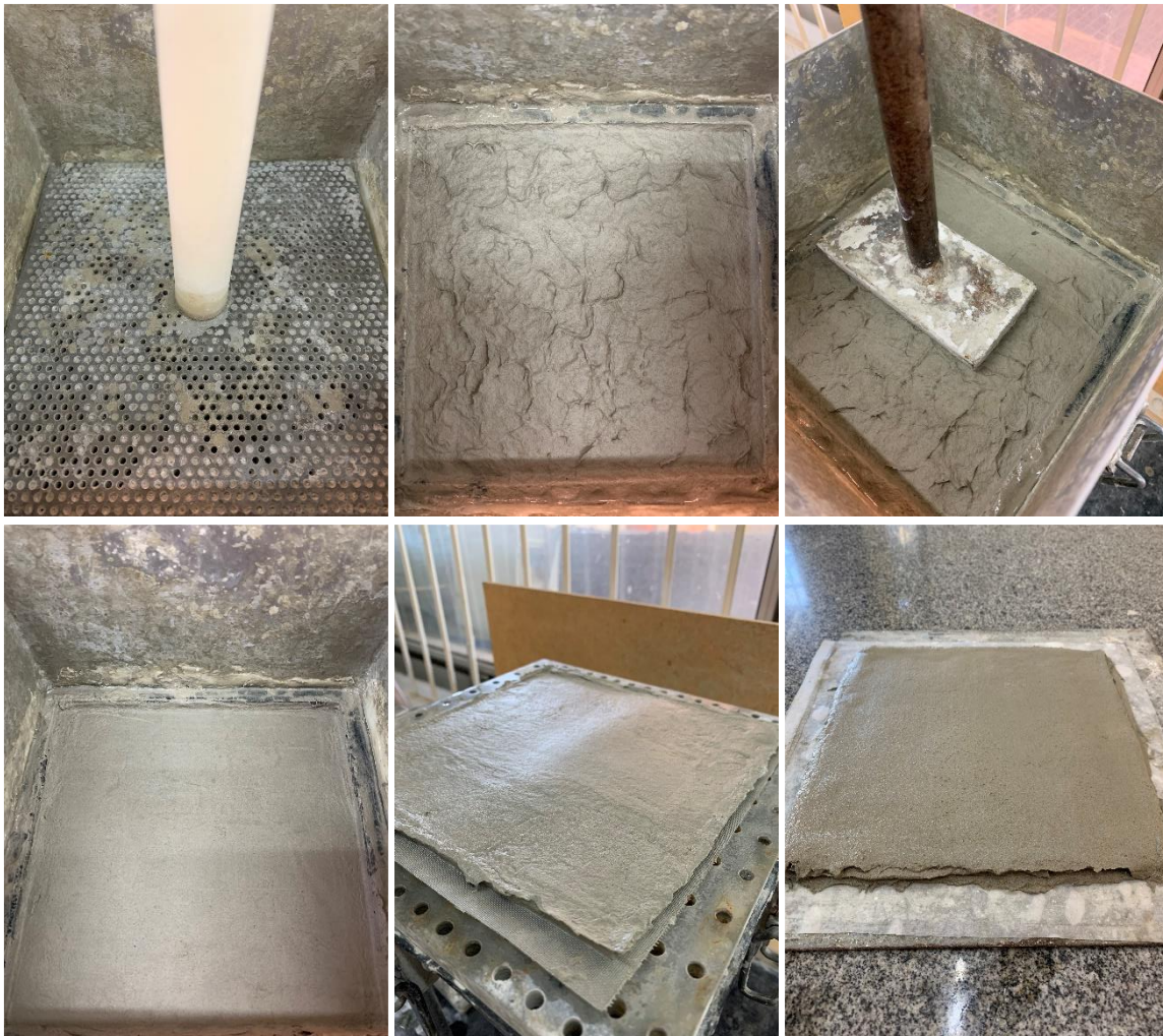
Figura 31 – Aparato de moldagem de fibrocimentos (a) com aplicação de vácuo, (b) retirada do soquete plástico, (c) adensamento com soquete metálico, (d) acabamento, (e) retirada da caixa superior e tamis e (f) sobreposição de três camadas para formar a placa de fibrocimento
