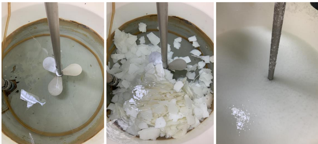
Figura 16 – Dispersão da polpa celulósica de eucalipto: (a) tanque de dispersão; (b) folhas de celulose rasgadas antes da dispersão; (c) polpa celulósica durante a dispersão
