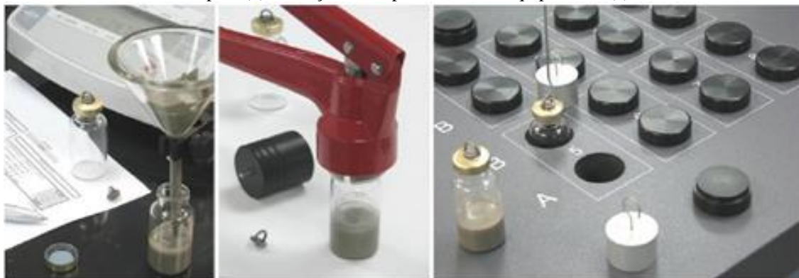
Figura 28 – Calorimetria isotérmica de pastas cimentícias: adição da pasta cimentícia na ampola (a), vedação da ampola (b) e locação da ampola dentro do equipamento (c)
