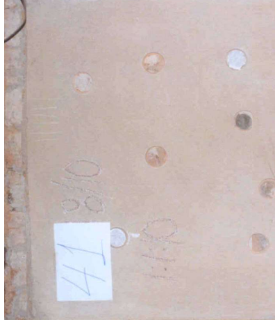
Figura 79: Revestimento feito com a amostra S21 LL e cal, na proporção 1:1:10 (cimento: cal: areia reciclada úmida), com acabamento liso, resistente e sem fissuras.
