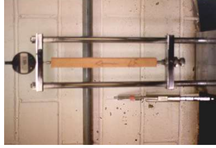
Figura 43: Aparelho comparativo da NBR 8490/84 usado para medida de retração linear por secagem em corpos-de-prova de 2,5 x 2,5 x 28,5 cm (MIRANDA, 2000).
