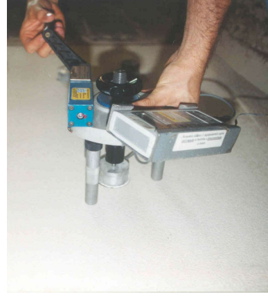
Figura 46: Ensaio de resistência de aderência à tração, com equipamento Dinatense, em revestimento de areia reciclada em Socorro/SP.
