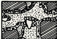
Figura 3.1. - Modelo simplificado de formação do concreto de cimento e polímero ( 53.54.55 )
