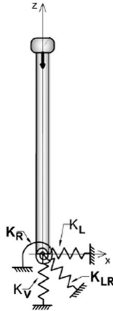
Figura 14 – Representação da rigidez da fundação.
