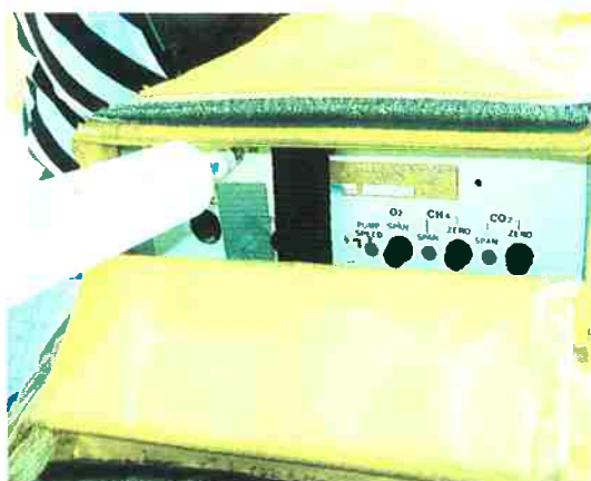
Figura 8.6 – Introdução do gás coletado no equipamento USP.
