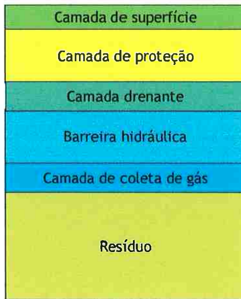
Figura 2.4 – Cobertura tradicional de aterros sanitários (Marinho, 2006)
