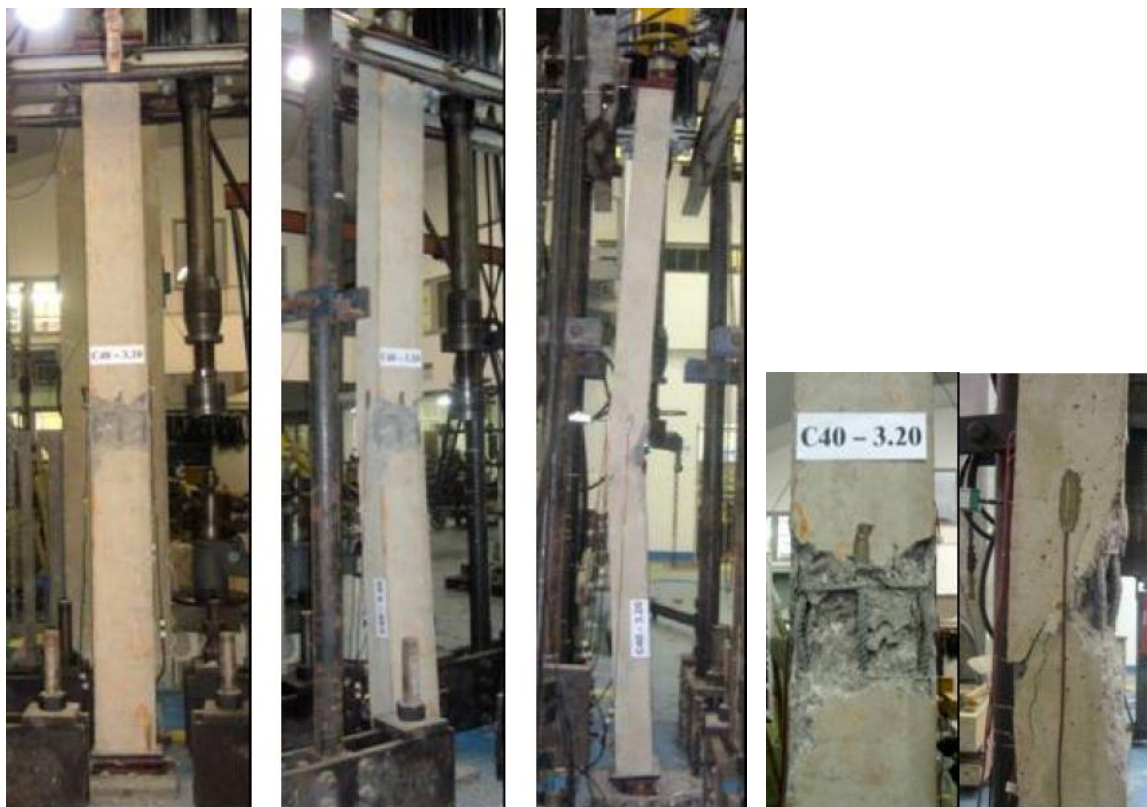
Figura 36 – Aspecto do pilar C40 – 3.20 após a ruptura (ENCISO, 2010)
