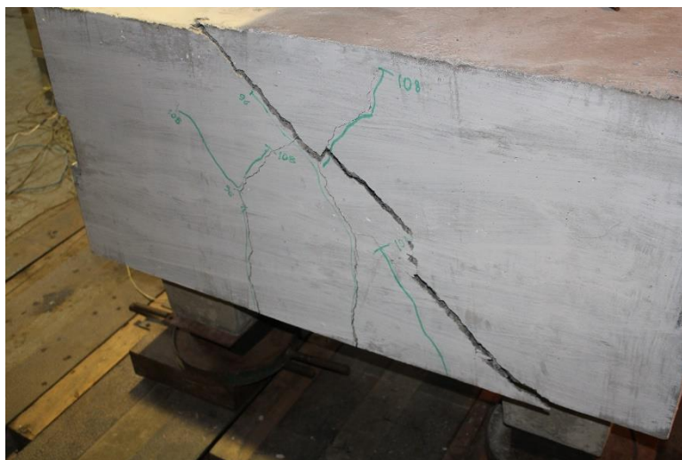
Figura 7.31 - Padrão de fissuração do bloco N1B45A1C após a ruptura
