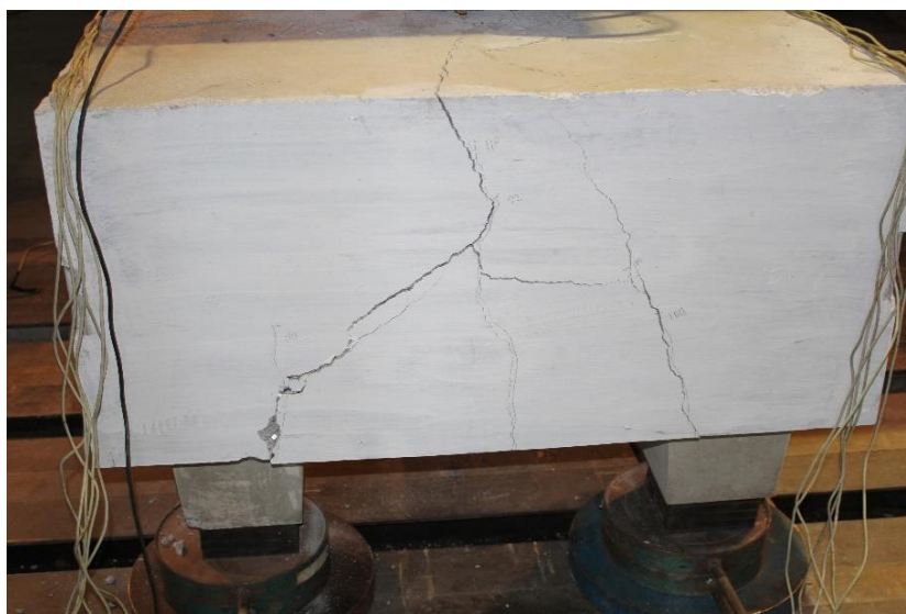
Figura 7.49 - Aspecto do bloco N1B45A2Cbis após a ruptura
