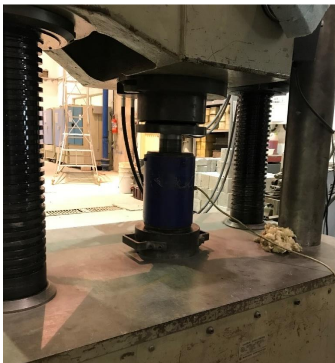
Figura 6.14 - Célula de carga sendo calibrada na Shimadzu (dia 29/08/2022)
