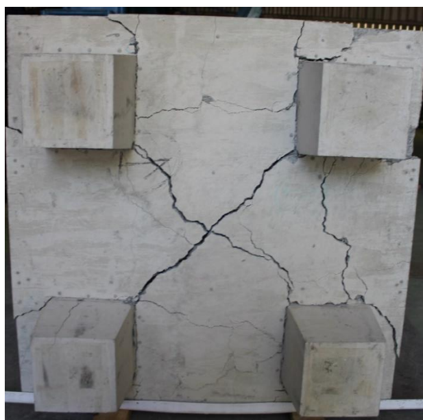
Figura 7.28 - Padrão de fissuração do fundo do bloco N2B45A2C após o ensaio
