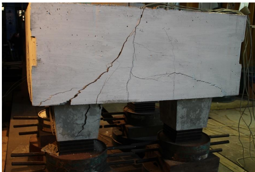
Figura 7.42 - Padrão de fissuração do bloco N2B45A2Cbis após a ruptura
