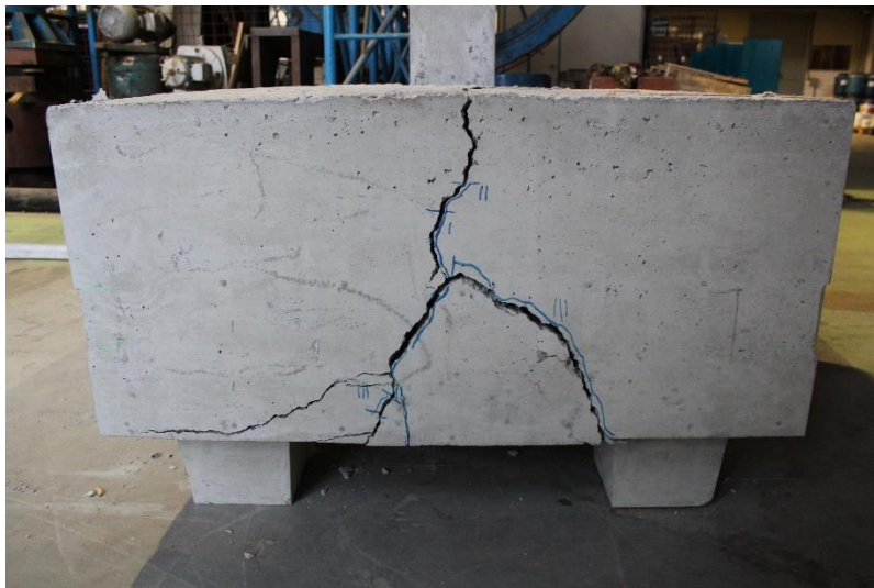
Figura 7.10 - Aspecto das fissuras do bloco N1B45A1D após a ruptura
