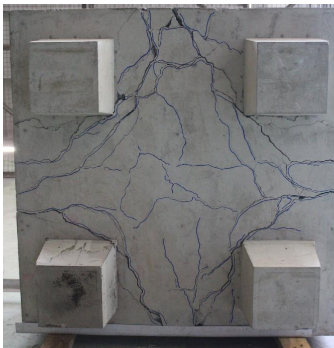
Figura 7.20 - Padrão de fissuração do fundo do bloco N2B45A1D após o ensaio
