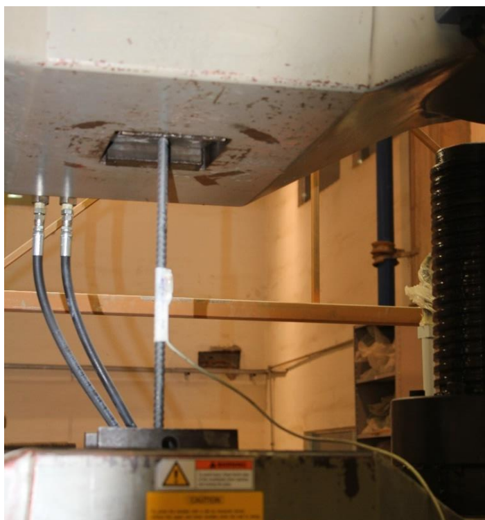
Figura 6.9 - Ensaio de tração de barra instrumentada realizado em 21/06/2018
