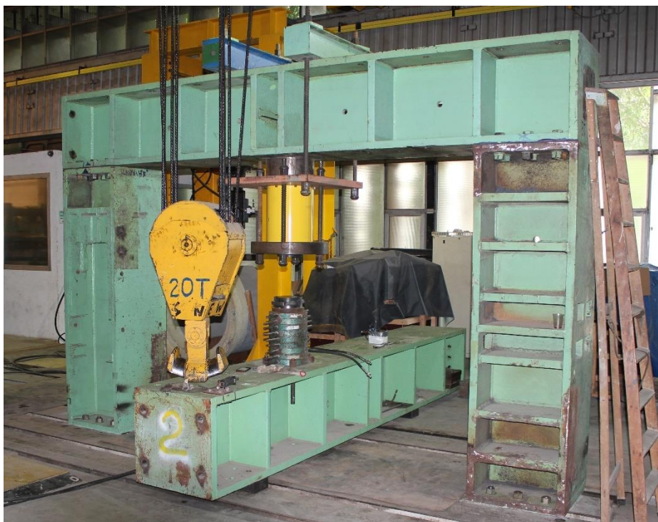
Figura 6.3 - Montagem do teste realizado no p3rtico de ensaio
