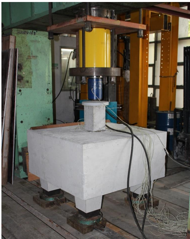
Figura 6.23 - Configuração de um ensaio com forma tipo N1
