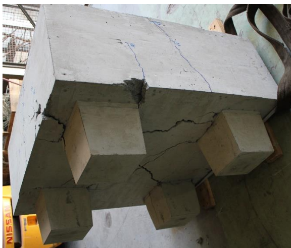
Figura 7.26 - Fissuração adicional ao X em um dos lados e destacamento concreto próximo a duas quinas de uma estaca para o bloco N2B45A2C
