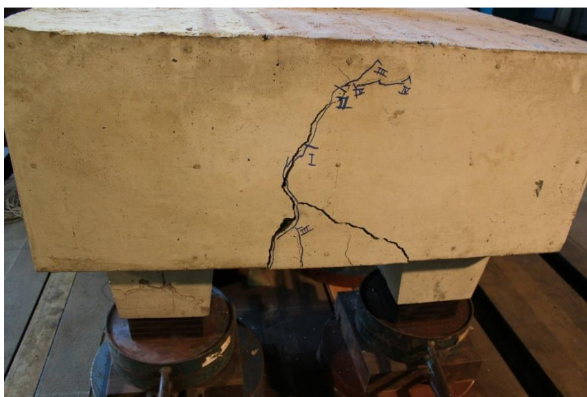
Figura 7.18 - Padrão de fissuração do bloco N2B45A1D após a ruptura
