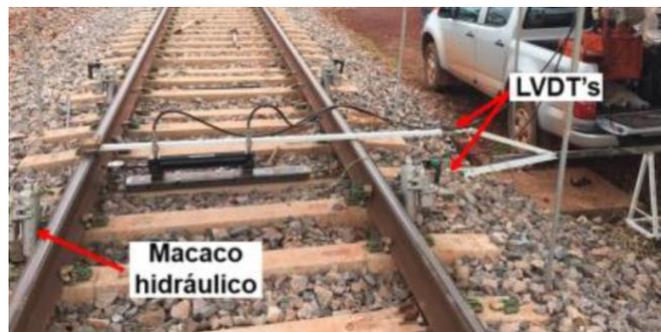
Figura 33. Sistema para a realização do STPT, desenvolvido e montado pelo LIM-USP, realizando teste em uma linha de pátio da EFC.
