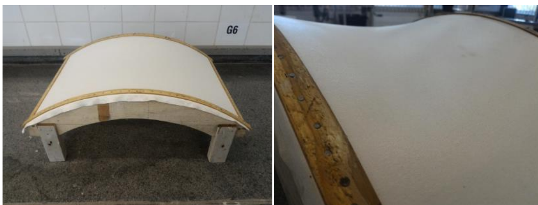
Figura 39 - Geometria de sela obtida com o retesamento da fôrma.
