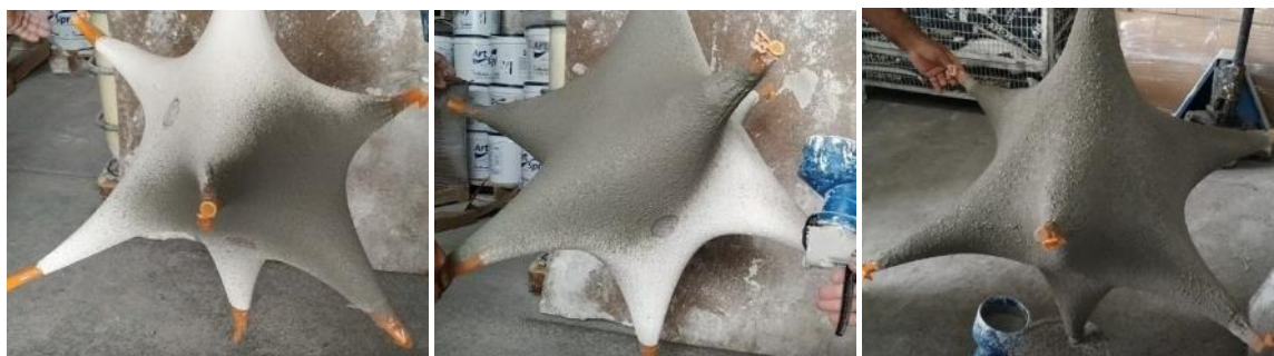
Figura 46 - Projeção da segunda camada sobre o molde tensegrity.
