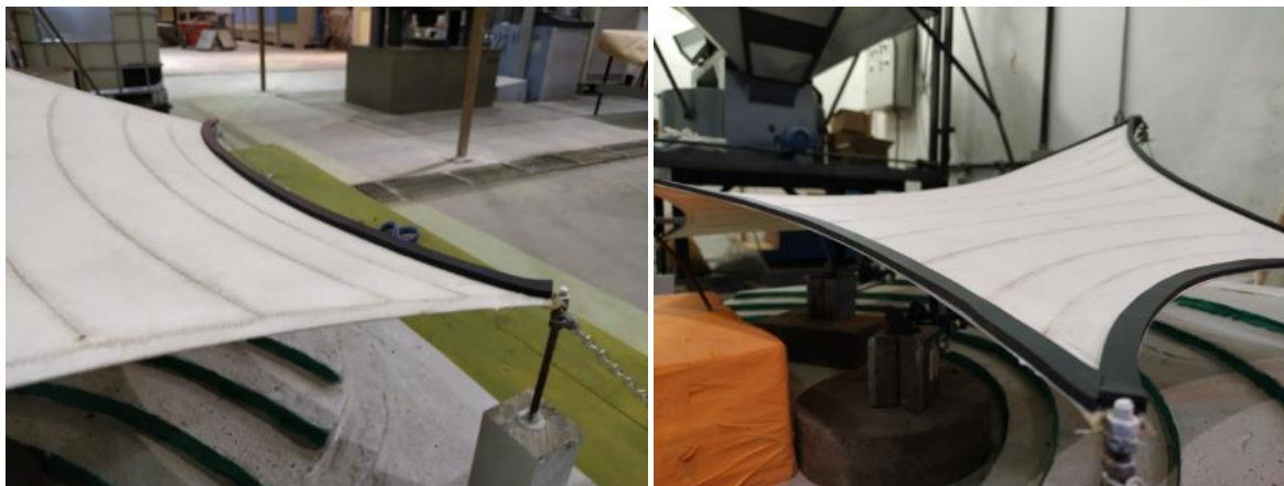
Figura 53 - Colocação do limitador de espessuras nas bordas da membrana.
