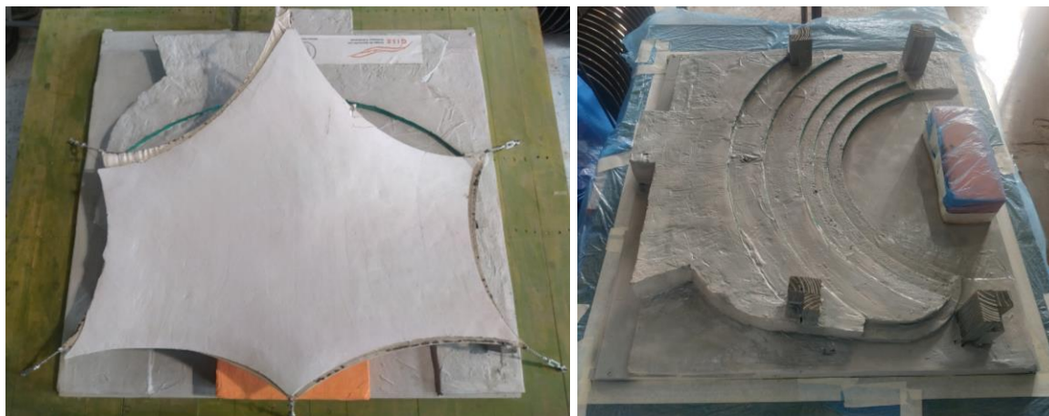
Figura 63 - Desmobilização da membrana, remoção da fôrma e readequação dos apoios.
