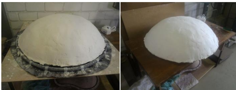
Figura 34 - Casca de gesso obtida com o molde pneumático.
