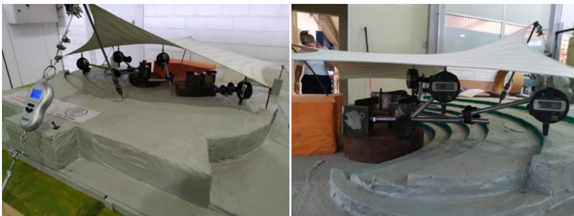
Figura 49 - Instrumentação do modelo em escala reduzida do MPBP.
