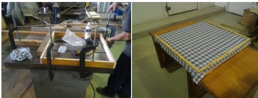
Figura 36 - Montagem do modelo de fôrma suspensa.
