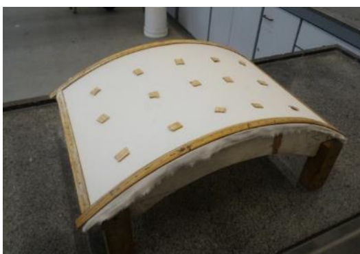
Figura 40 – Uso de espaçadores para controle da espessura da casca em sela.
