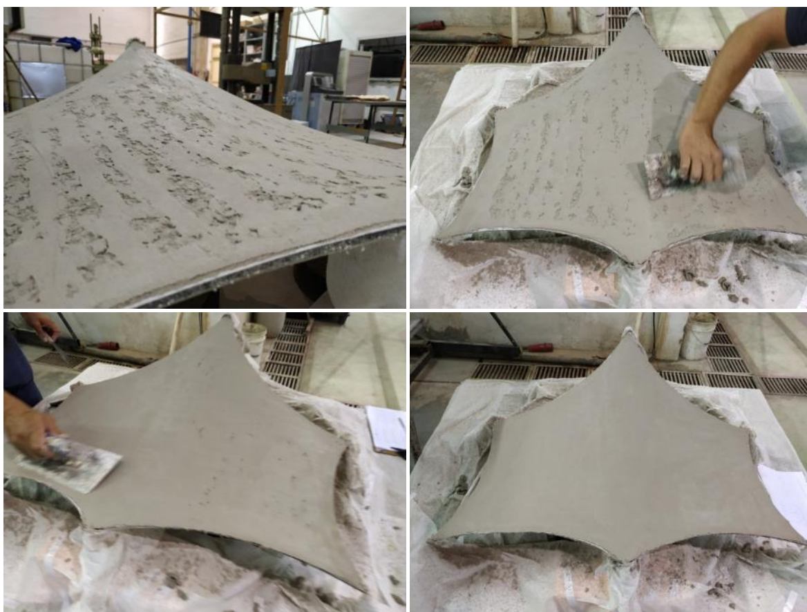
Figura 57 - Finalização do acabamento da casca.
