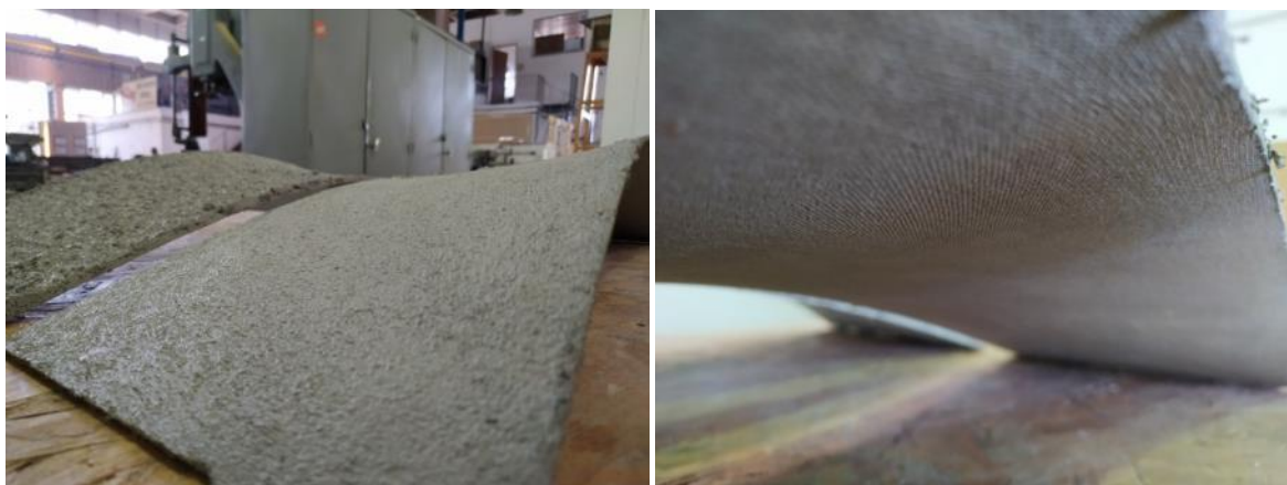
Figura 43 - Casca em sela obtida com a argamassa projetada: (a) acabamento da superfície superior dado pelo aplicador; (b) acabamento da superfície inferior em contato com a fôrma.
