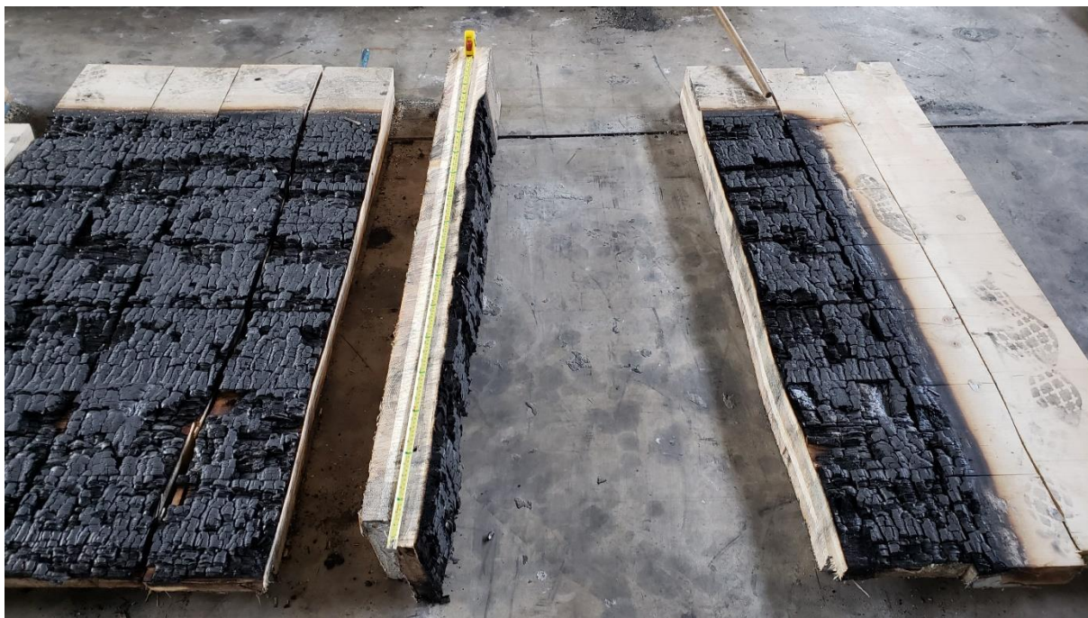
Figura 4.31 - Vista lateral do painel de CLT usinado após o teste.
