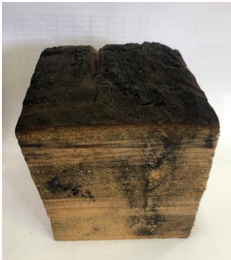
Figura 4.18 - Carbonização na região de nós.
