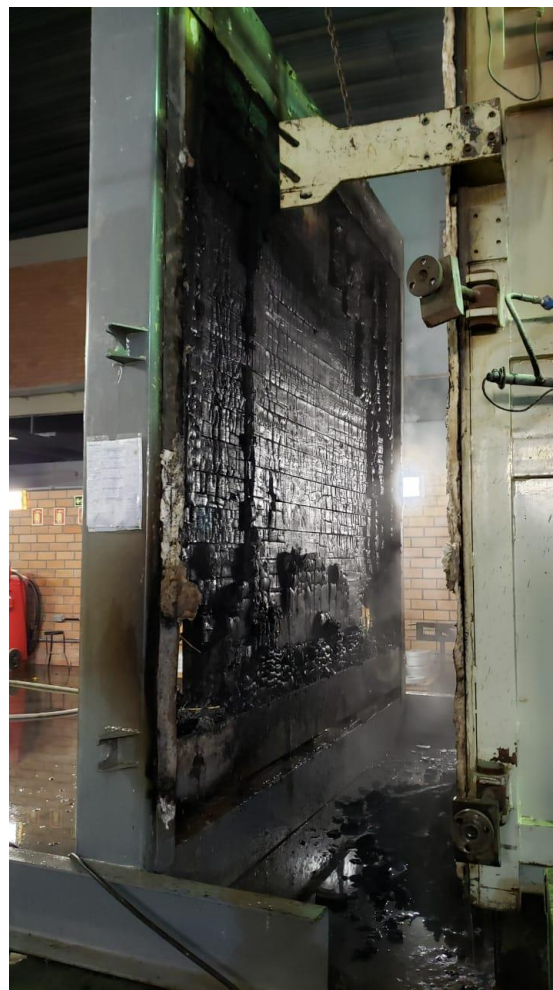
Figura 4.40 - CLT após o deslocamento.
