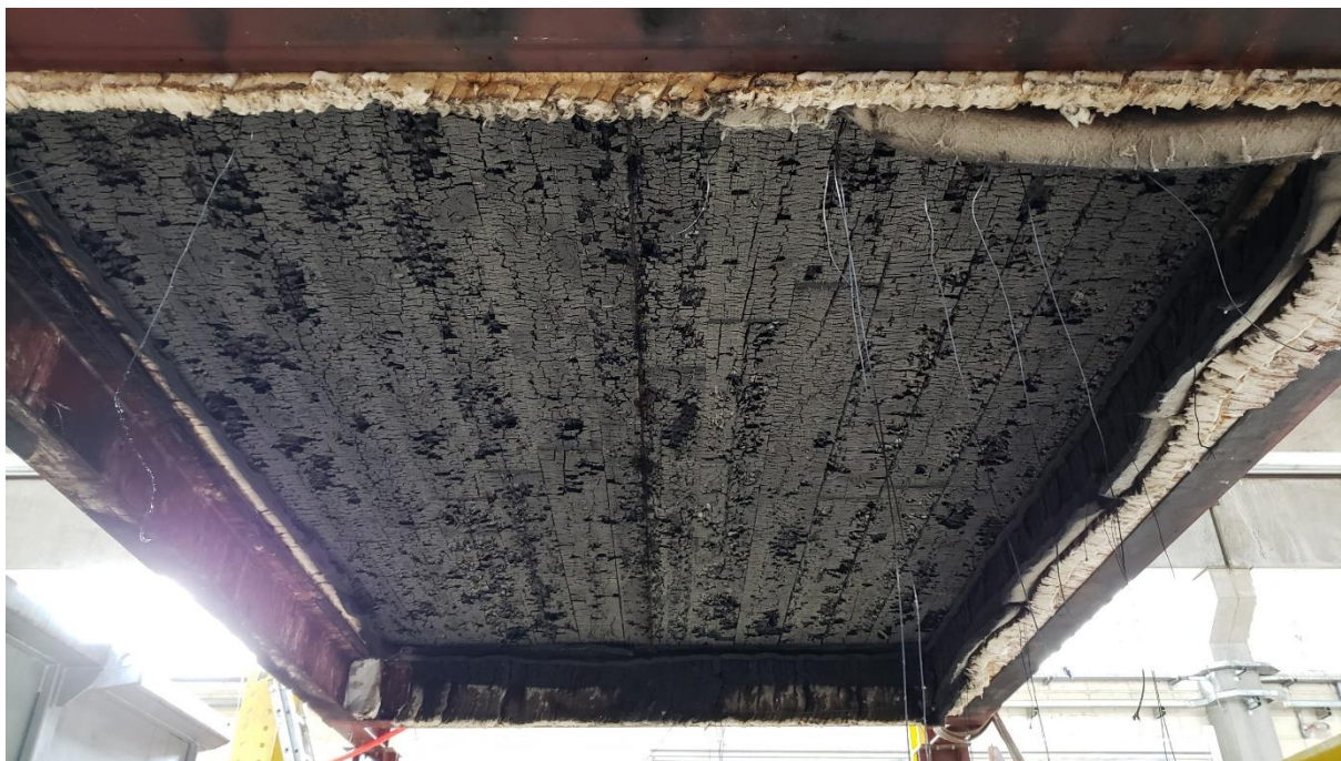
Figura 4.27 - Vista inferior da laje de CLT após o ensaio.
