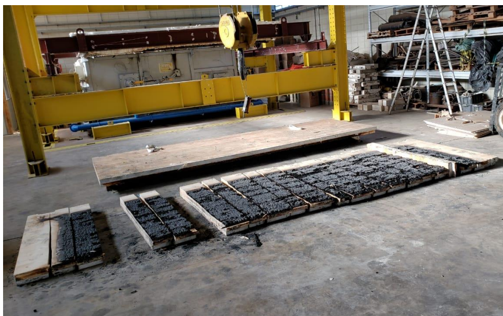
Figura 4.10 - Pannel de CLT cortado em 21 peças.
