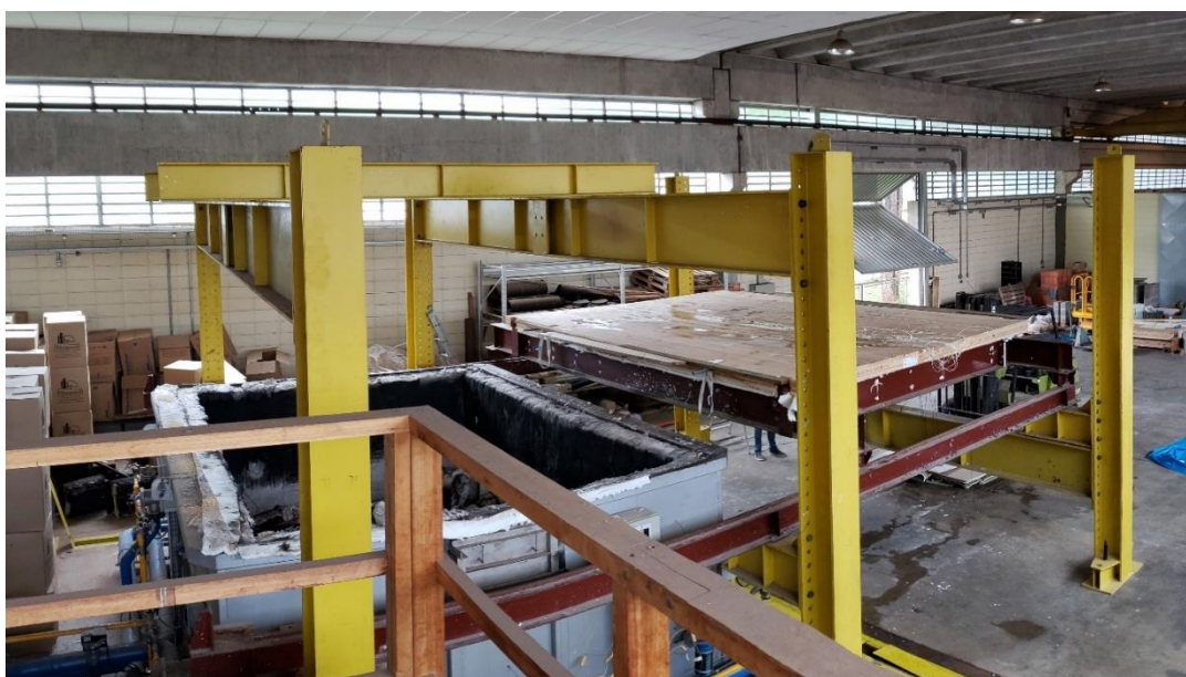
Figura 4.26 - Laje de CLT sendo removida do forno.
