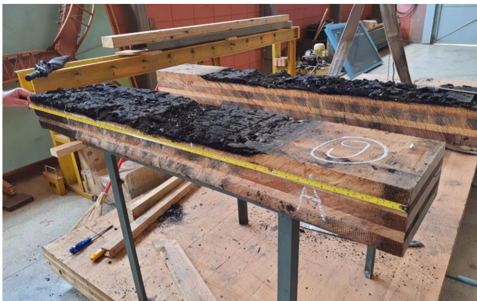
Figura 4.11 - Peça de CLT posicionada sobre a mesa para demarcação da malha.
