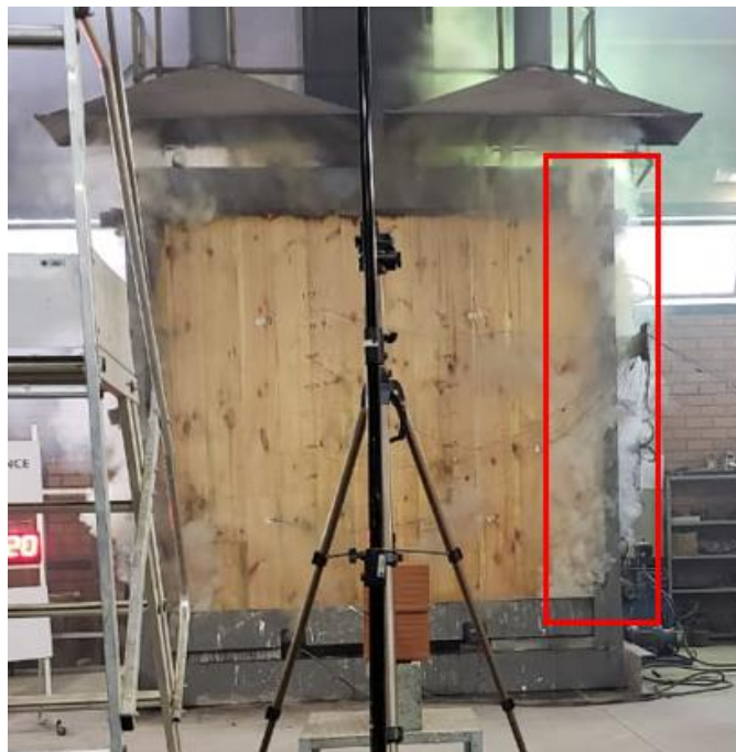
Figura 4.35 - Passagem de fumaça entre o painel e o forno vertical.
