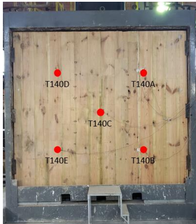
Figura 3.18 - Distribuição dos termopares na parede de CLT.
