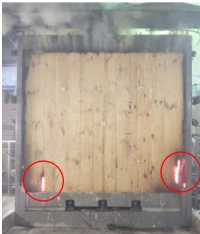
Figura 4.37 - Aberturas na parede de CLT durante o ensaio de resistência ao fogo.
