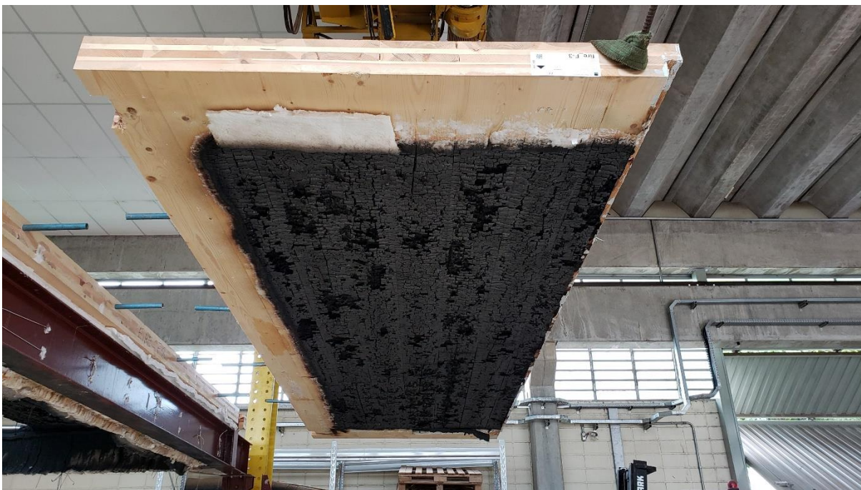
Figura 4.29 - Vista inferior de meia laje de CLT após o ensaio.
