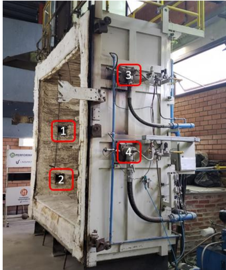
Figura 3.20 – Vista dos queimadores a gás.
