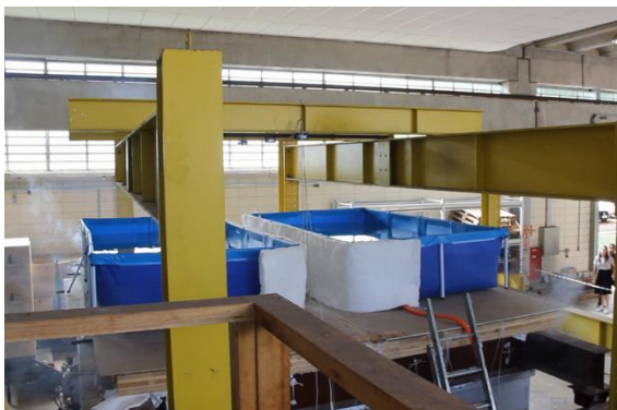
Figura 4.3 - Passagem de fumaça entre o painel de CLT e a parede do forno.
