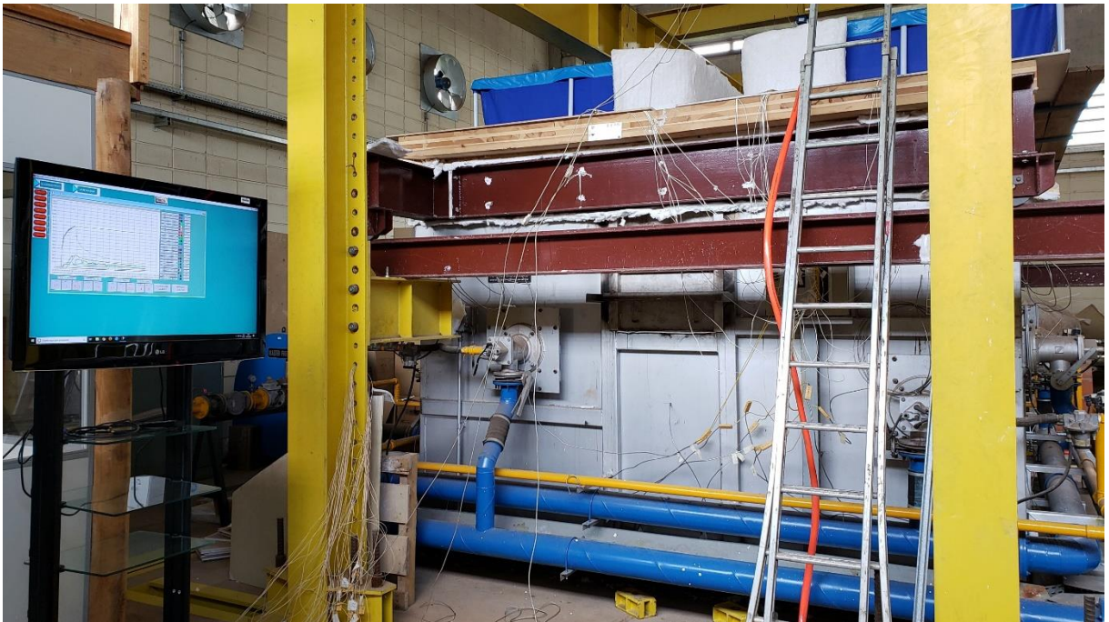
Figura 3.14 - Termopares conectados ao painel de controle.
