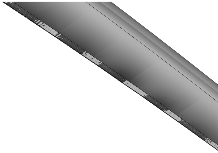
Figura 51 – Deformação do bordo de fuga na carga crítica ( q_x = 12,94kN/m ).
