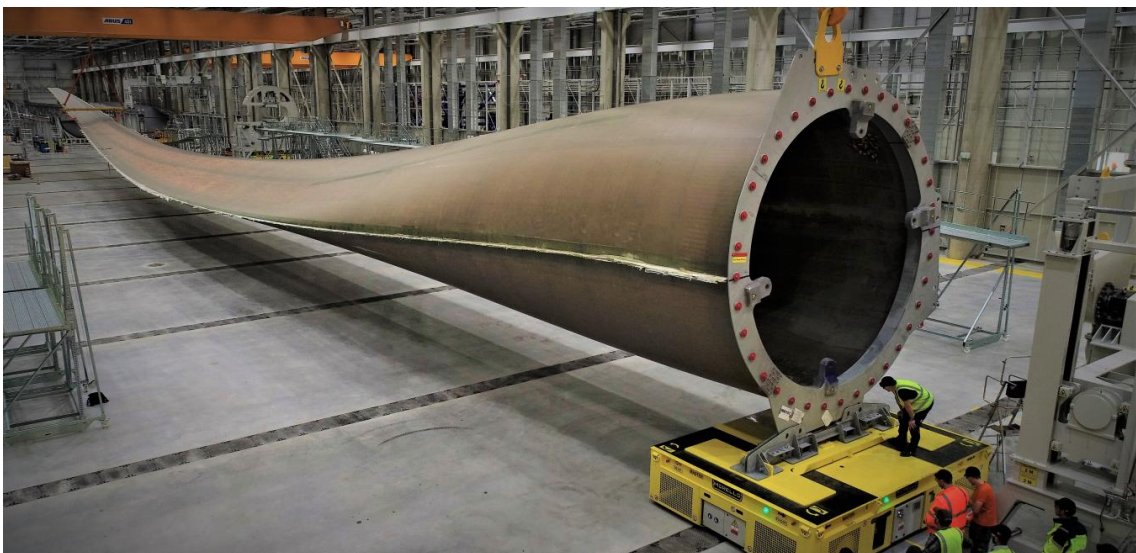
Figura 3 – Pás da turbina offshore Haliade-X 12MW, com 107m de extensão
