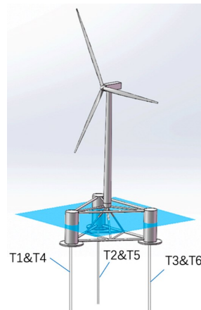
Figura 16 – Conceito de TLP com dois tendões por flutuador
