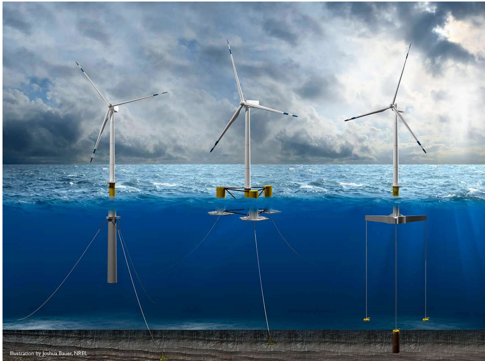
Figura 4 – Plataformas eólicas flutuantes, da esquerda para a direita: SPAR; semissubmersível e TLP
