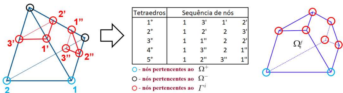
Figura 55: Decomposição do domínio em células de integração para o elemento de fluido com CD (caso 01).
