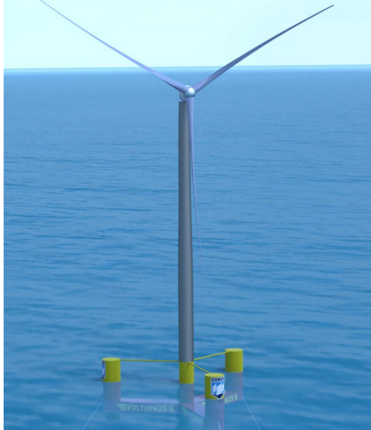
Figura 29 – Turbina IEA-15-240 RWT suportada pela plataforma de referência UMaine VoltturnUS-S.
