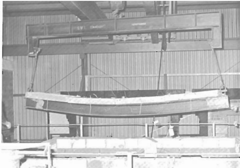
Figura 2.6 – Viga mista sendo removida do forno após um dos ensaios
