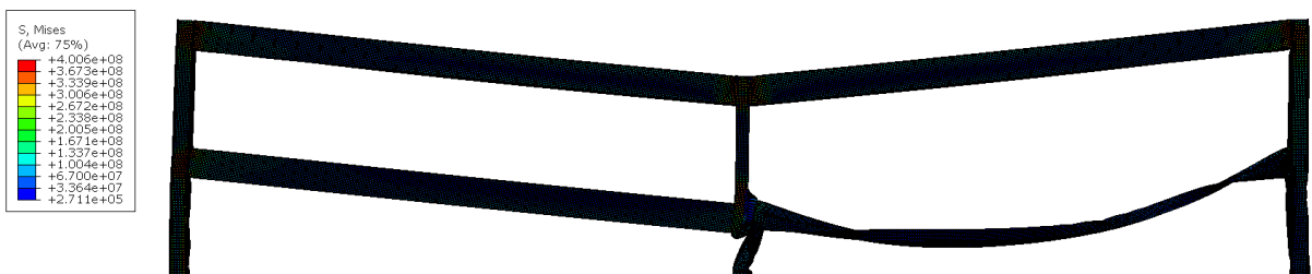
Figura 5.90 – Configuração deformada do modelo P2-I2-15m-80% ao fim de 24 minutos de incêndio
