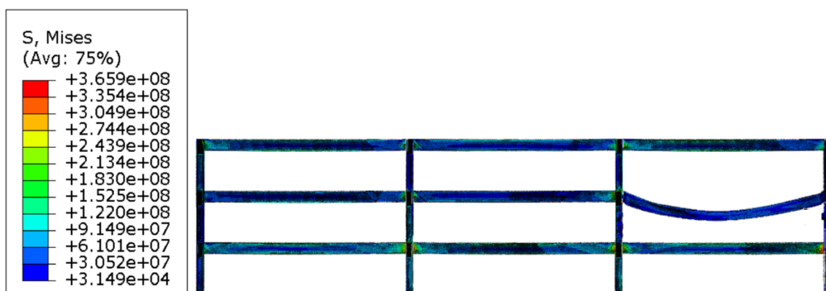
Figura 5.423 – Configuração deformada do modelo P3-I1-15m-PR-PML-80% ao fim de 30 minutos de incêndio
