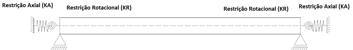
Figura 4.22 – Representação do modelo estrutural da viga isolada com a indicação das molas que simulam a rigidez axial e rotacional dos apoios
