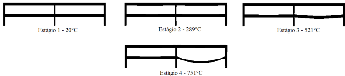
Figura 5.162 – Processo de colapso de pórticos com 15 metros de vão com pilares revestidos contra o fogo sob cenário de Incêndio 2
