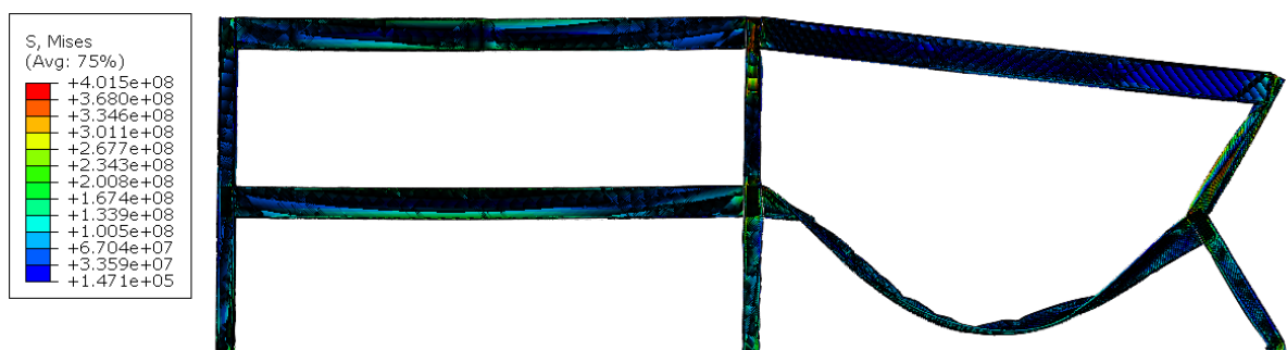
Figura 5.163 – Configuração deformada do modelo P2-I2-10m-VR-PR-80% ao fim de 54 minutos de incêndio – cenário de incêndio 2
