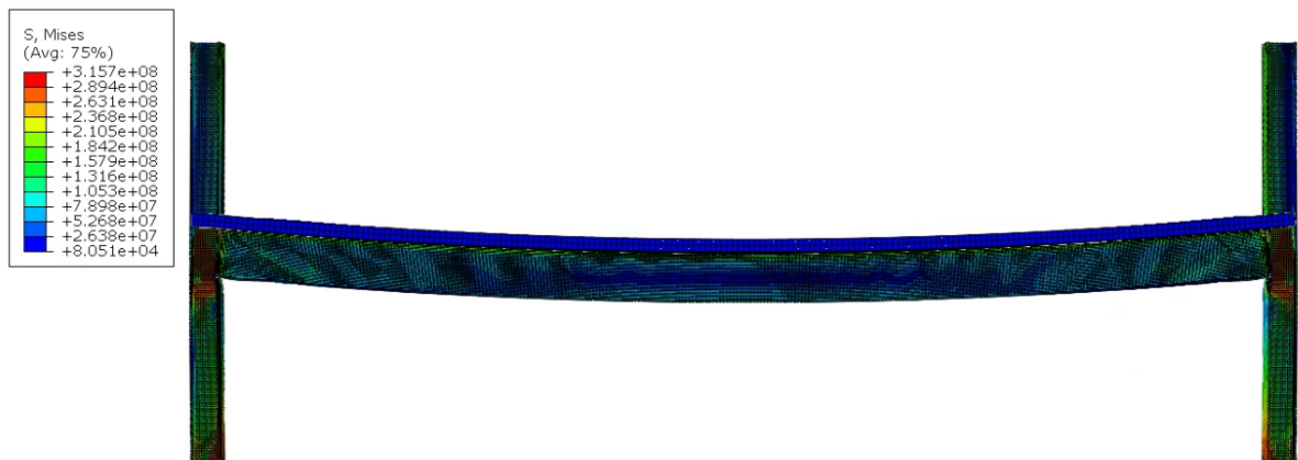
Figura 5.49 – Distribuição de tensões de Von-Mises no modelo PM1-15-0.1KA-KR-PR
