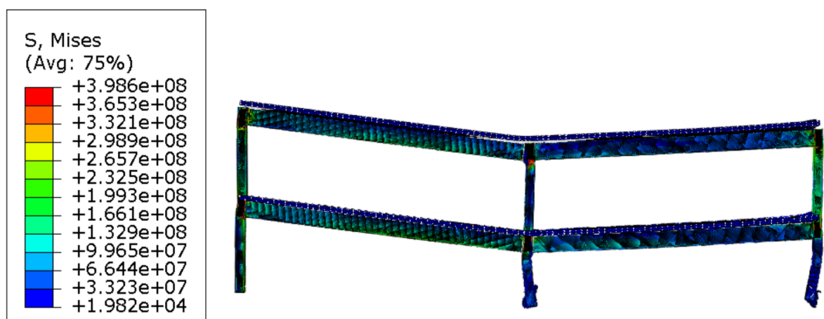
Figura 5.242 – Configuração deformada do modelo PM2-I2-10m-VR-80% ao fim de 30 minutos de incêndio – cenário de incêndio 2
