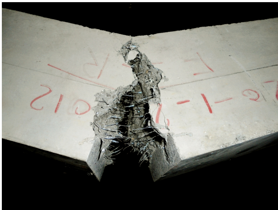
Figura 1.1: Fibras de aço “costurando” a fratura (< https://www.ipt.br/ >, acessado em março de 2020).
