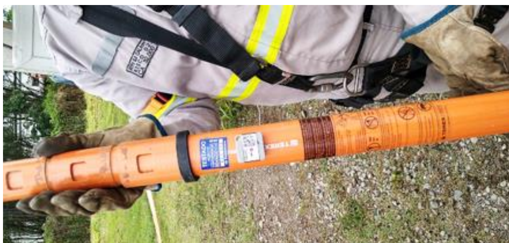
Figura 70 - Sensor fixado na vara de manobra com detector de tensão
