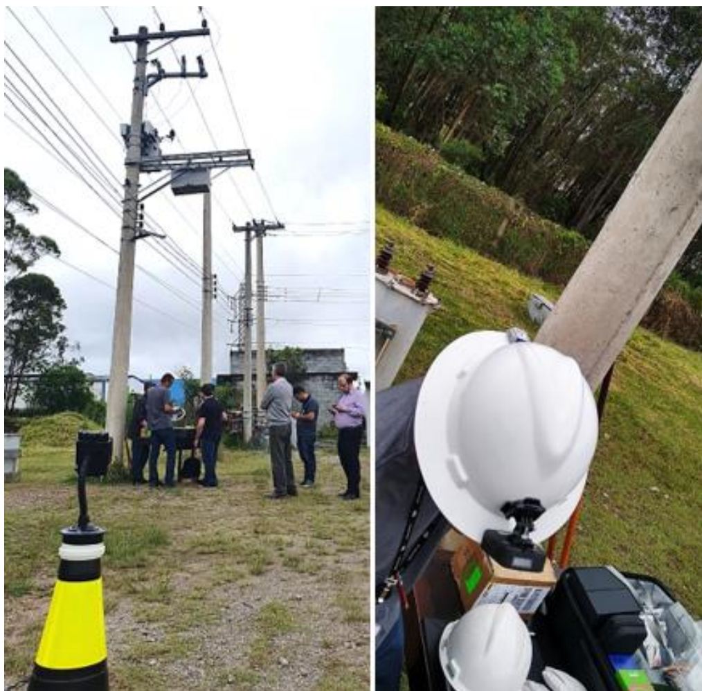
Figura 69 - SBCAM fixada no cone e no capacete
