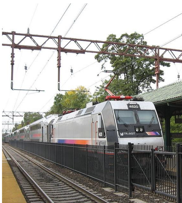
Figura 5.2 – Locomotiva Bombardier ALP-46 e carros MultiLevel Coach do sistema ferroviário de Nova Jersey. Fonte: modificado de Wikipedia (2022a).
