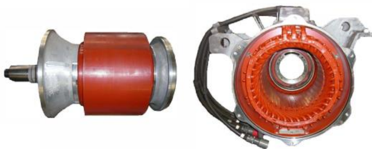
Figura 3.19 – Interior de motor síncrono de ímãs permanentes ferroviário após 361.000 quilômetros em serviço no metrô de Tóquio. Fonte: modificado de Shikata et al. (2012).
