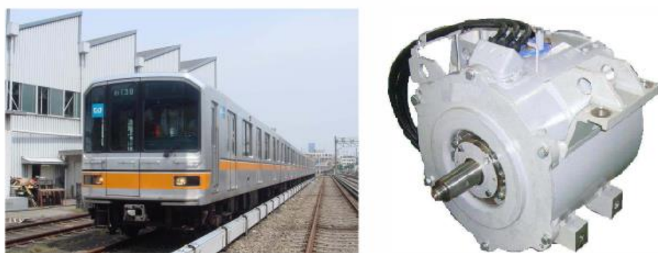
Figura 4.1 – Composição Série 01 da Linha Ginza do Metrô de Tóquio e respectivo PMSM. Fonte: modificado de Shikata et al. (2012).
