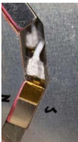
Figura 3.11 – Sensor de termoresistência acoplado a ímãs de rotor de PMSM para medição de temperatura. Fonte: modificado de Choi et al. (2018).
