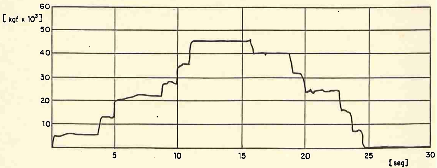
Figura 3.9 - Sinal de saída do amplificador após o filtro de compensação em pesagem dinâmica com veículo de 6 eixos
