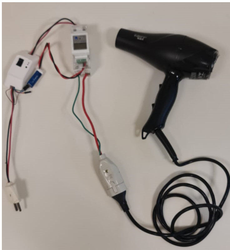
Figura 14 – Instalação do medidor de energia no Secador
