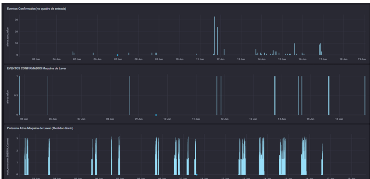
Figura 55 – Gráfico de detecção de eventos com o gráfico de Potência Ativa da carga (Geladeira) e o quadro de entrada
