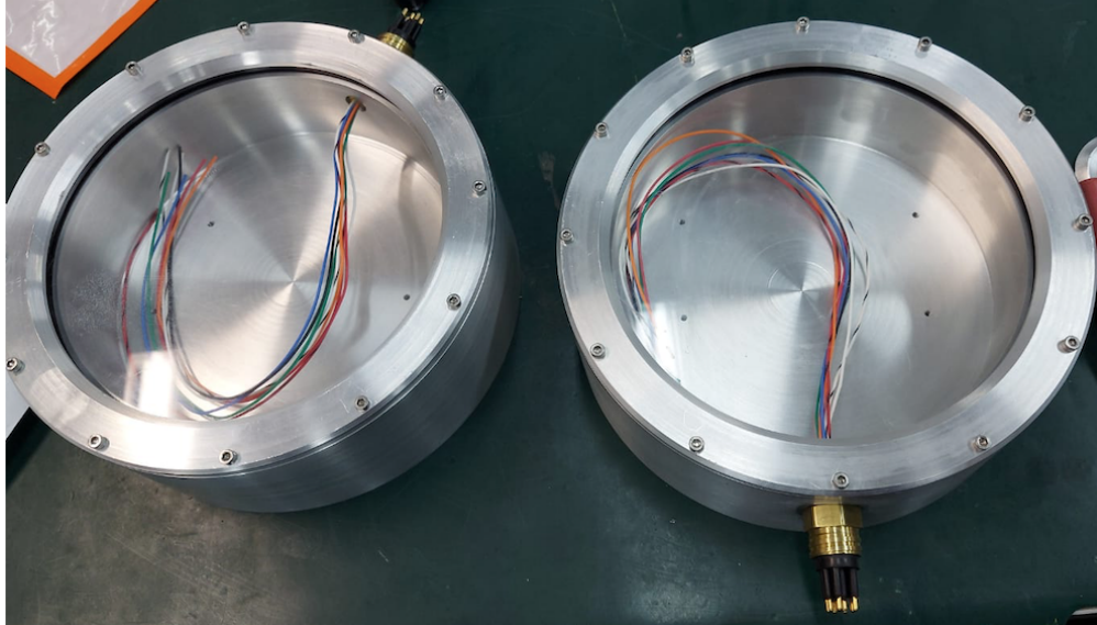
Figura 86: Vasos estanques de alumínio com diâmetro máximo de 203 mm e altura máxima de 70 mm. Fonte: Autor.
