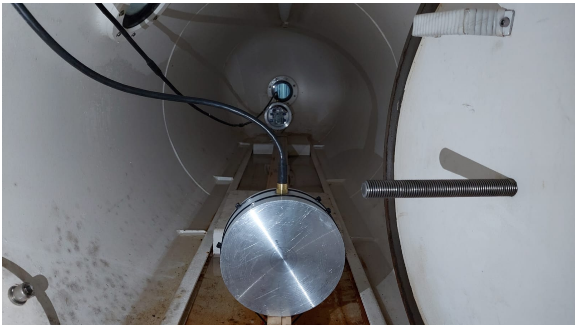
Figura 89: Posicionamento dos modems no interior da câmara hiperbárica. Fonte: Autor.
