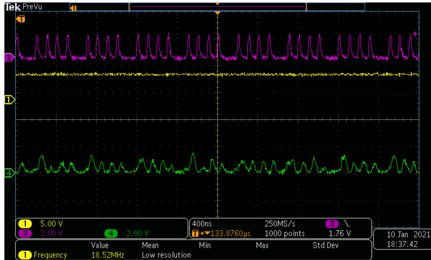
Figura 60: Teste de resposta do SiPM ao transmissor com geração de pulsos a 10 MHz, duty cycle de 25 % e alta iluminação de fontes externas, com a exibição da corrente consumida pelos LEDs (roxo), da saída do sensor após amplificação (verde) e da saída digitalizada do SiPM (amarelo). Fonte: Autor.
